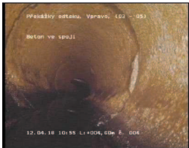
Foto 004 Videopáska: 1/1 Stav H-R 4,60 m 3 - 5 Uhr Překážky odtoku, Vpravo; Beton ve spoji
