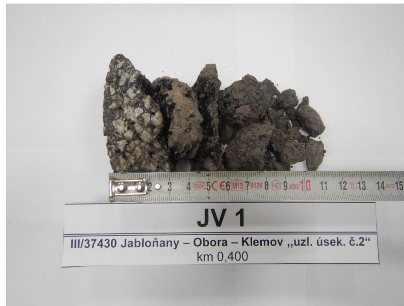
Foto č. 4 – Detail vývrtnu JV 1 (úsek č.2)
