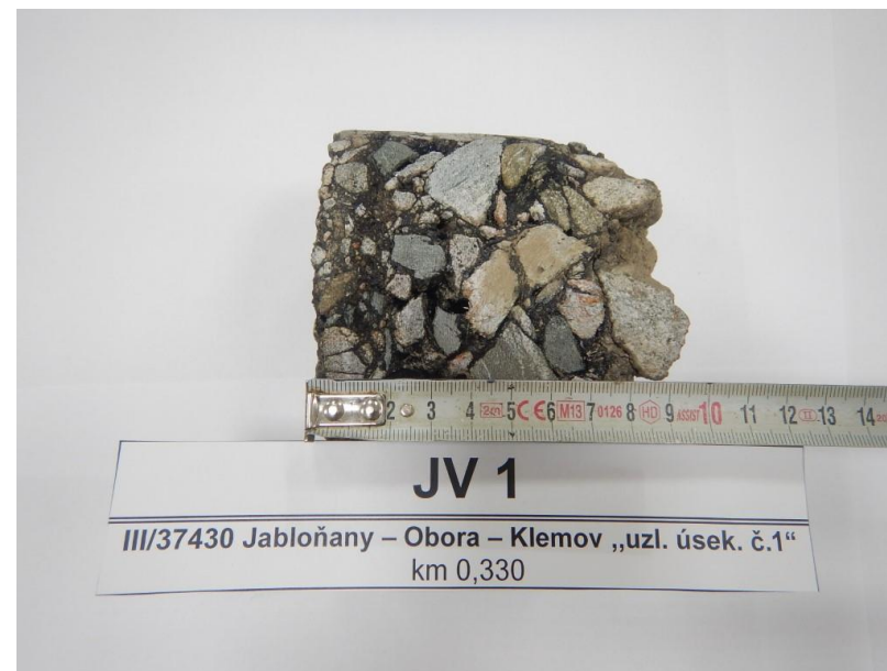
Foto č. 2 – Detail vývrtnu JV 1 (úsek č.1)
