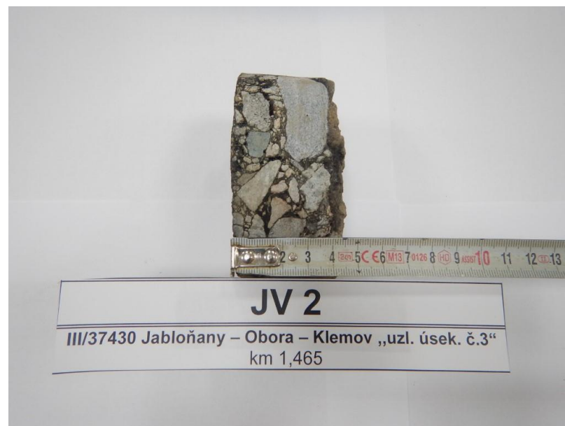
Foto č. 10 – Detail vývrtnu JV 2 (úsek č.3)
