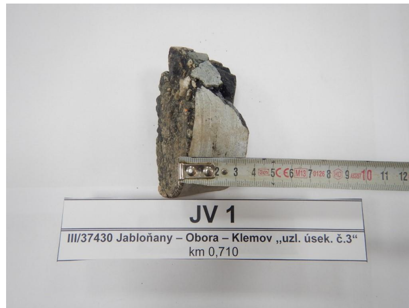
Foto č. 8 – Detail vývrtnu JV 1 (úsek č.3)
