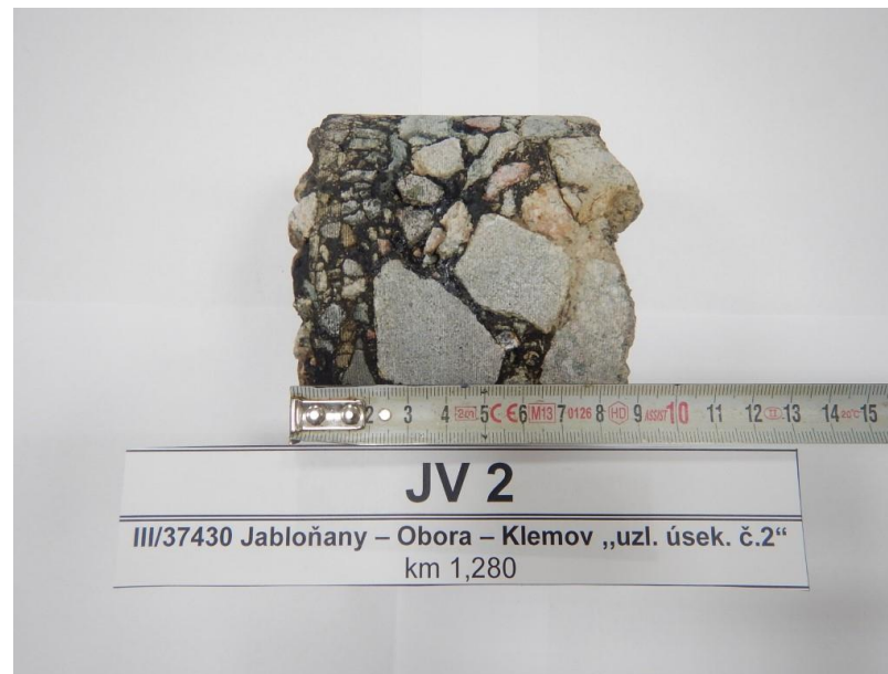
Foto č. 6 – Detail vývrtnu JV 2 (úsek č.2)
