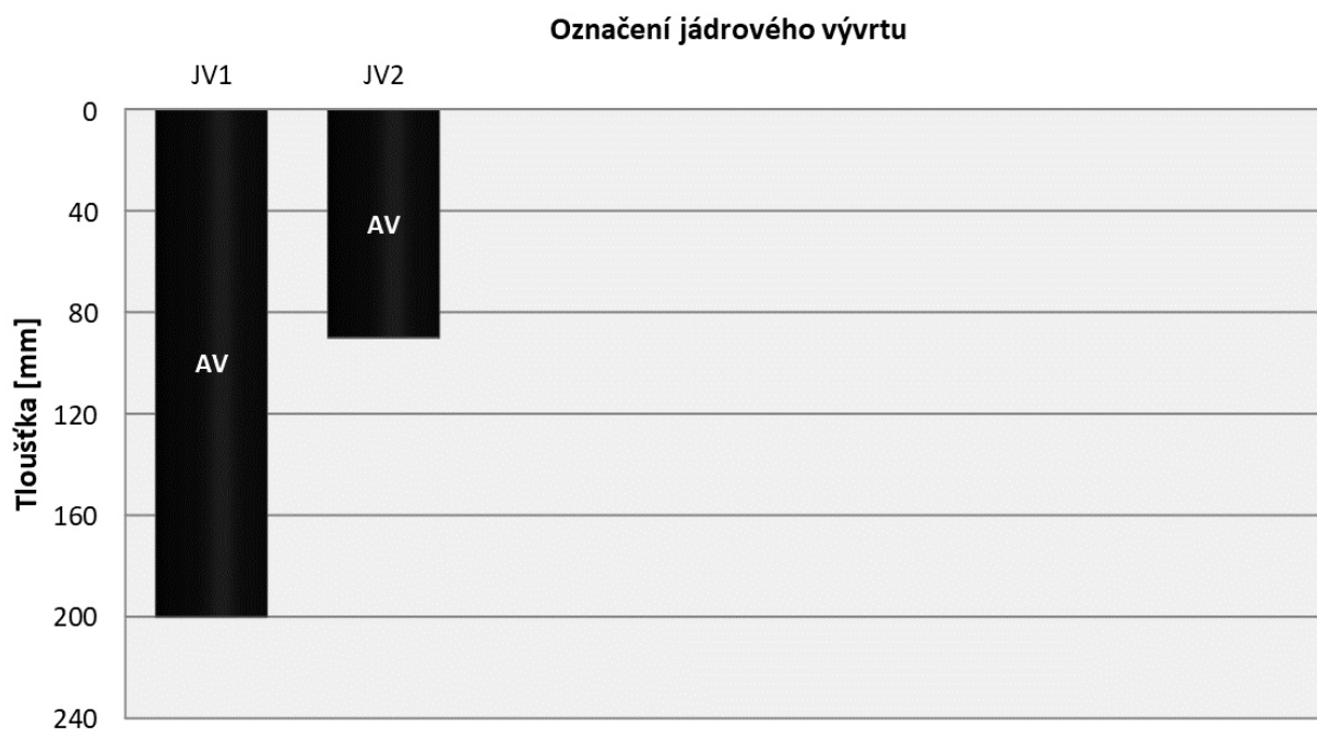
Graf 1: Jádrové vývrty – tloušťky vrstev vozovky
