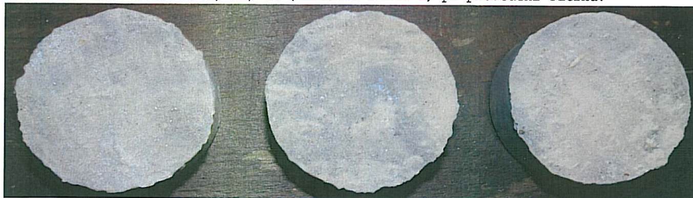
Obr. 8 Zkušební terče č.44, 45, 46 (zkušební místo 8) po provedení odtrhu.
