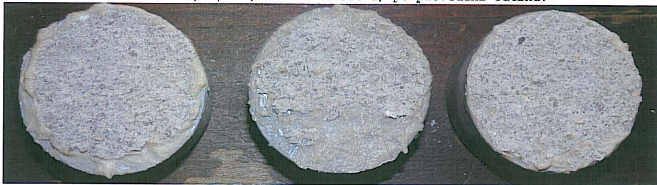
Obr. 1 Zkušební terče č.1, 2, 3 (zkušební místo 1) po provedení odtrhu.
