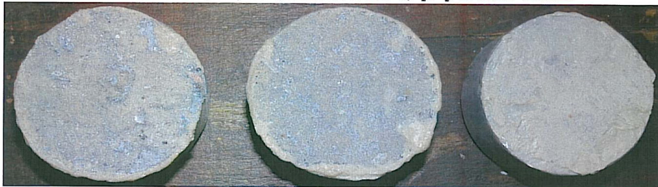
Obr. 5 Zkušební terče č.31, 32, 33 (zkušební místo 5) po provedení odtrhu.
