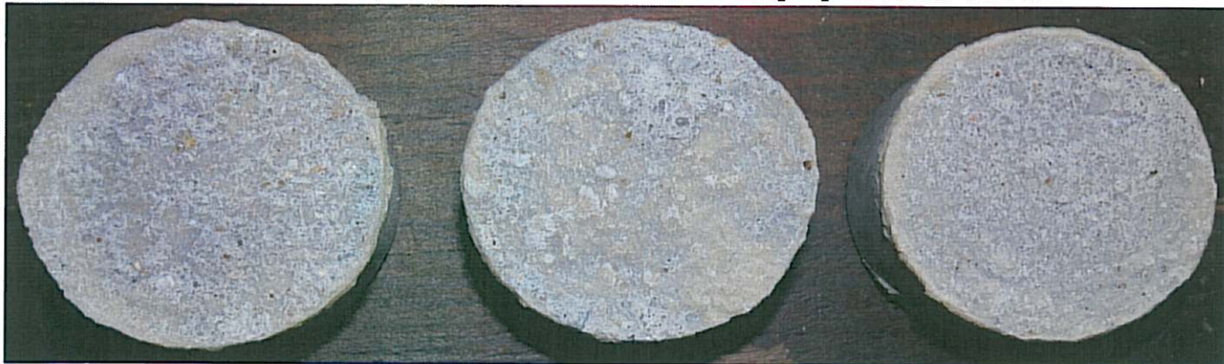
Obr. 4 Zkušební terče č.24, 25, 26 (zkušební místo 4) po provedení odtrhu.
