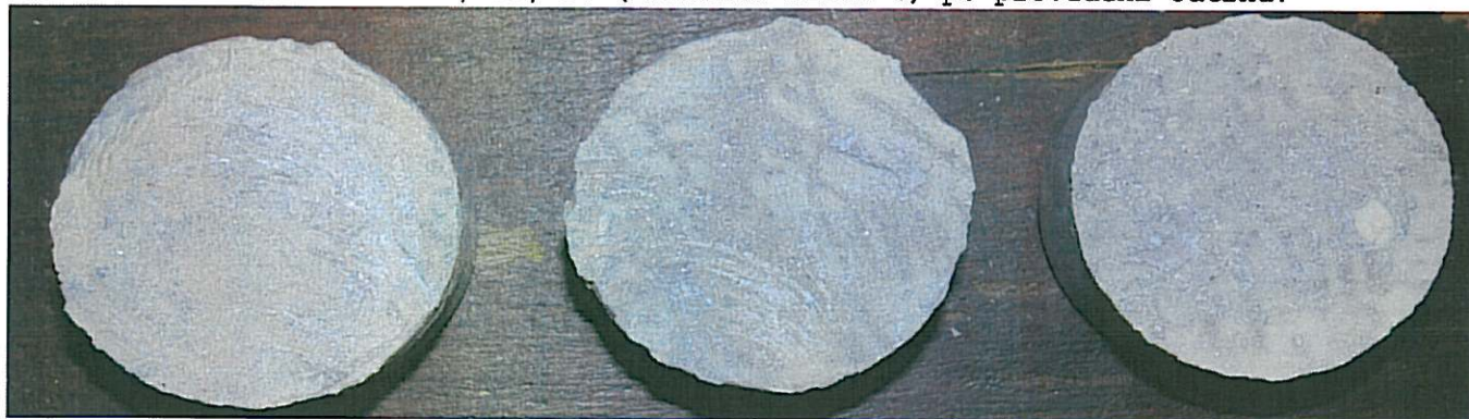
Obr. 6 Zkušební terče č.34, 35, 36 (zkušební místo 6) po provedení odtrhu.
