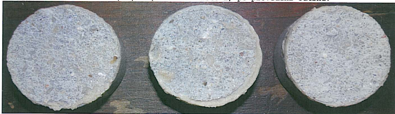
Obr. 2 Zkušební terče č.4, 5, 6 (zkušební místo 2) po provedení odtrhu.
