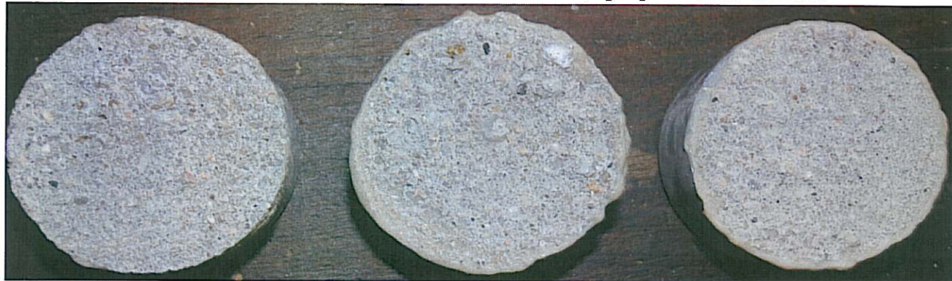
Obr. 4 Zkušební terče č.24, 25, 26 (zkušební místo 4) po provedení odtrhu.
