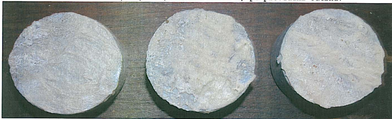
Obr. 8 Zkušební terče č.44, 45, 46 (zkušební místo 8) po provedení odtrhu.
