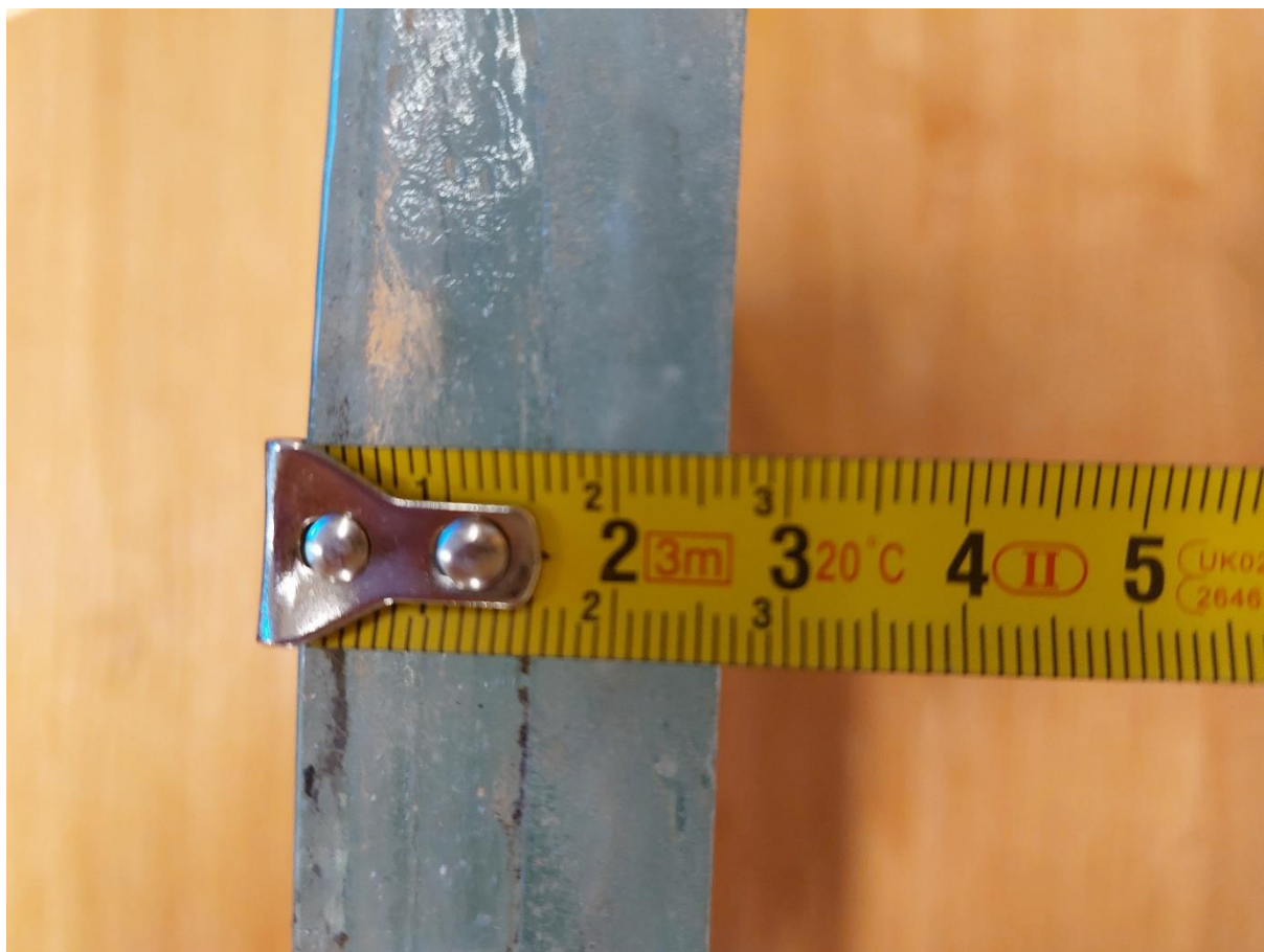
Foto 9 – orientační rozměr skleněné dlaždice – výška dlaždice
