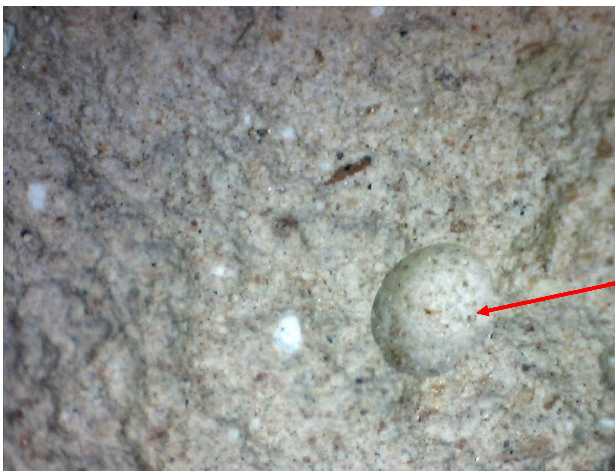
Hmota románského cementu při makroskopickém zvětšení. Vpravo je patrná vzduchová bublinka s ostrými konturami, vzniklá při zalévání či městnání materiálu do formy.
