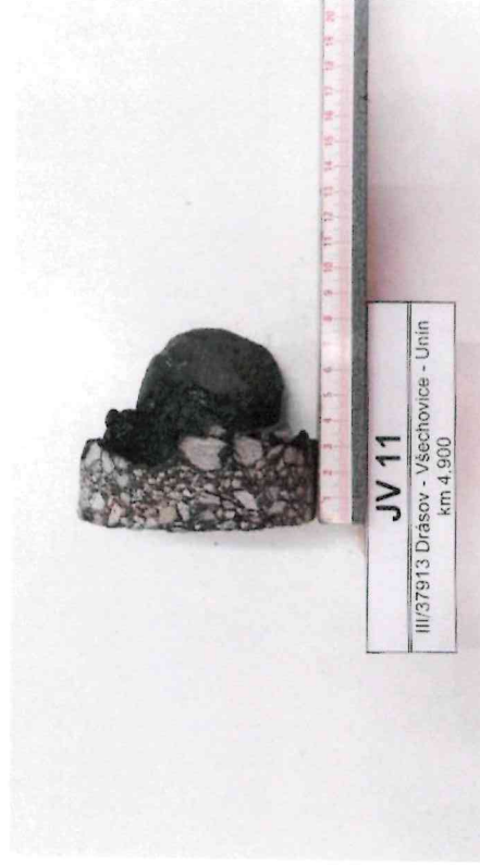
Foto č. 11 – Detail vývrtnu č. 11
