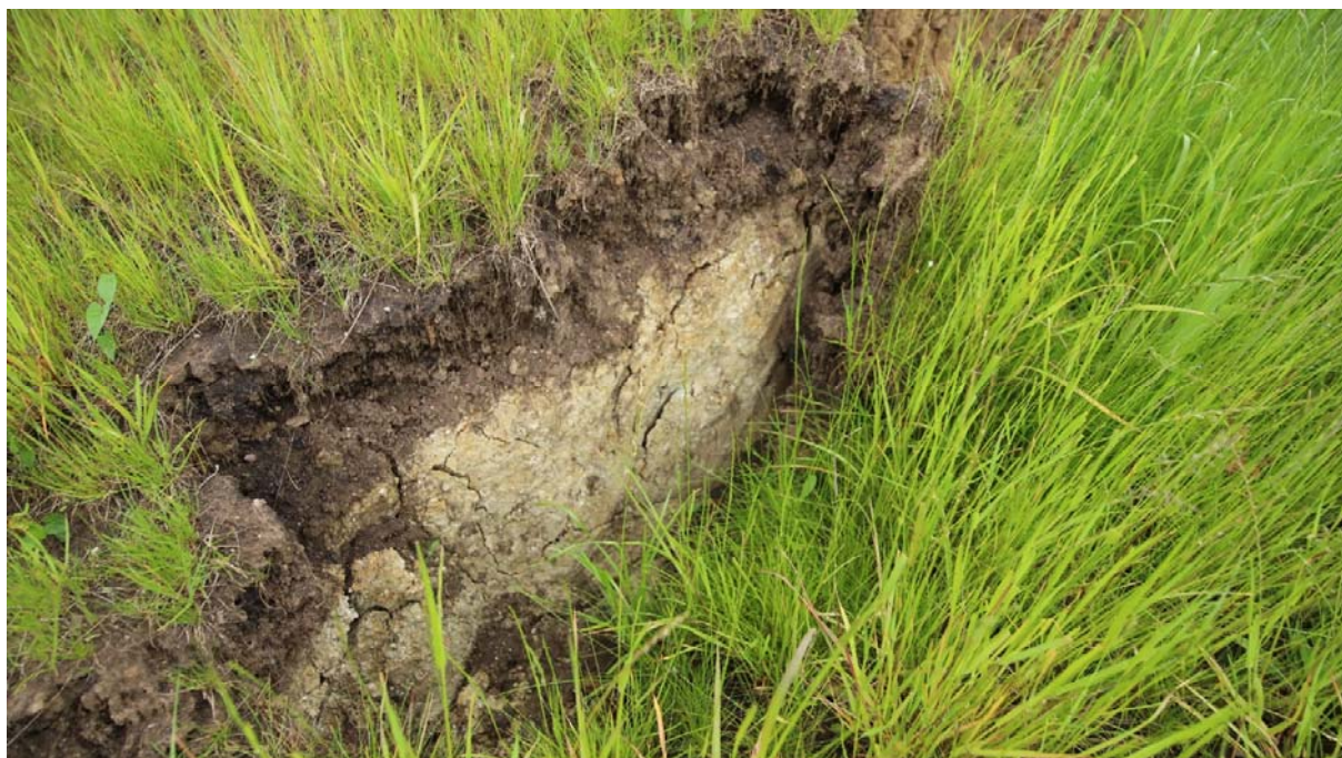
Obrázek 17: detail krajní kluzné svislé plochy v jílovitých zeminách s vegetačním krytem svahů v mocnosti 0,1 – 0,15 m
