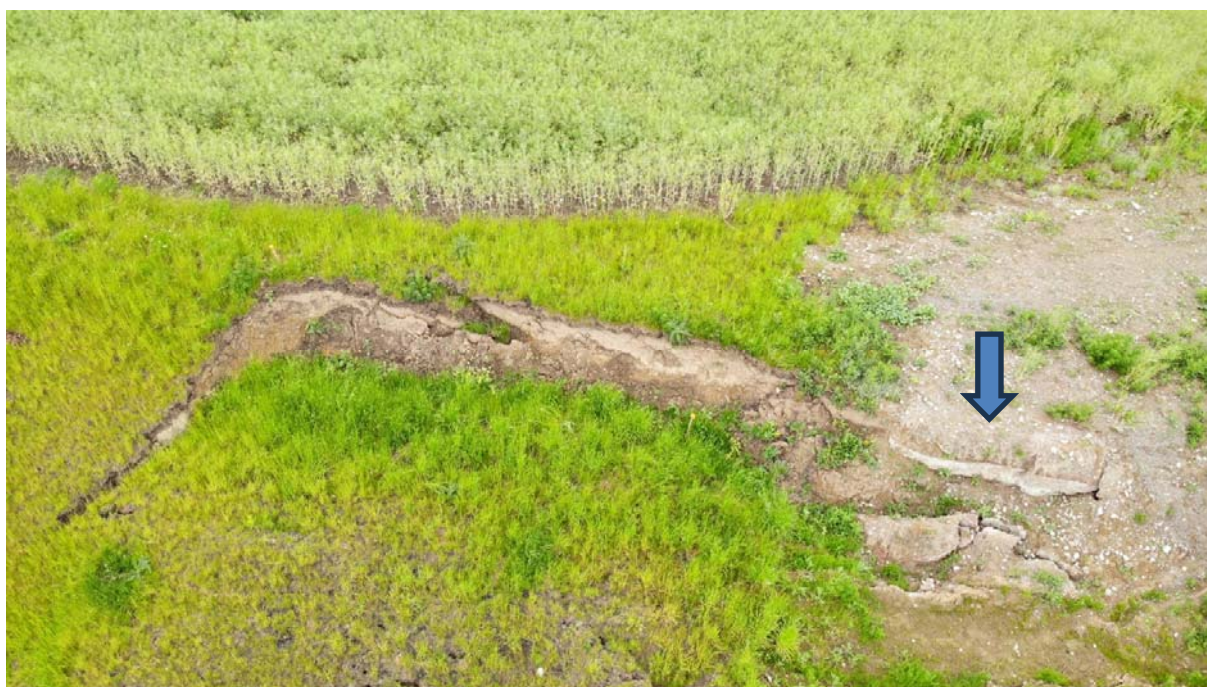
Obrázek 11: hlavní odtrhová linie sesuvu s označeným betonovým fundamentem a jeho zbytky níže po svahu, fundament byl sesuvem narušen a částečně transportován
