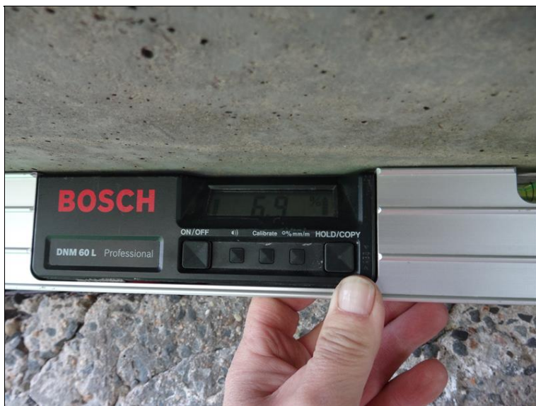
64.JPG Změřené stočení pravého hl. nosníku k jeho vnitřní straně.
