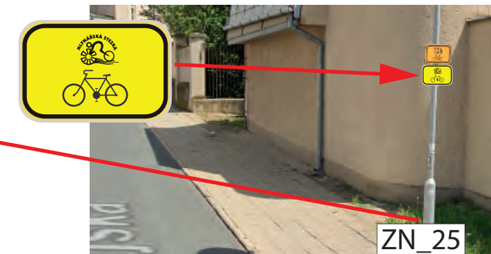
UL. DYJSKÁ: INSTALOVAT NA SLOUP OSVĚTLENÍ IS21a (MLYNÁŘSKÁ)
