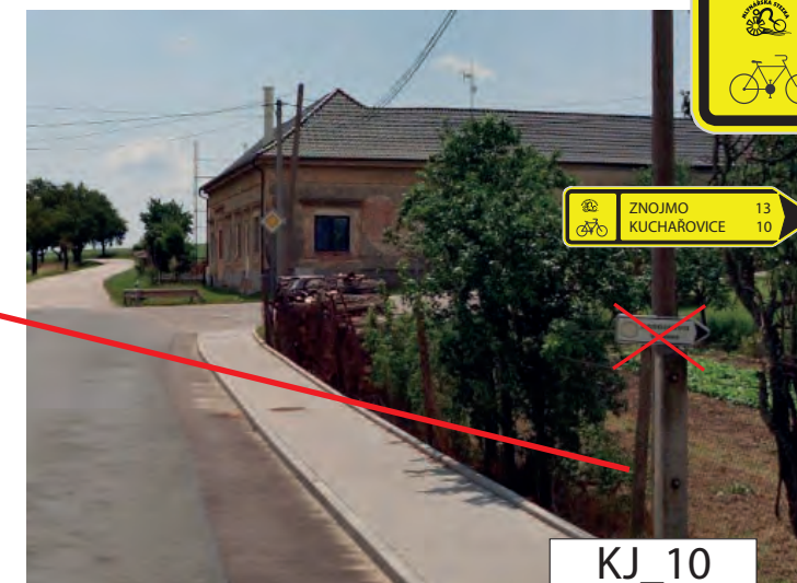
INSTALACE IS19c (MLYNÁŘSKÁ) NA DŘEVĚNÉM SLOUPU DEMONTÁŽ REKLAMY
