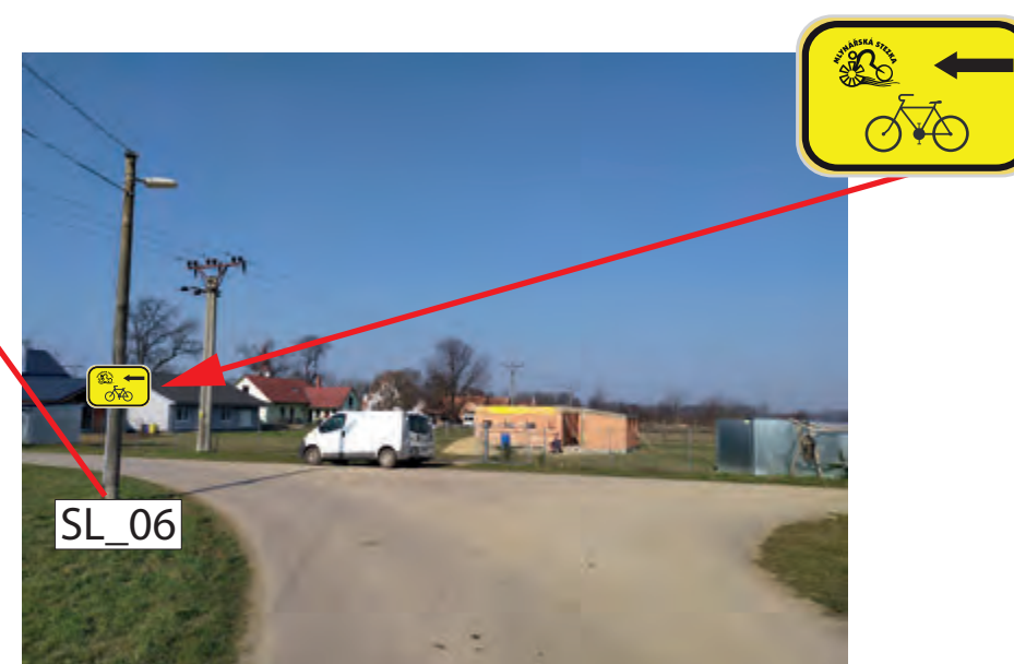
INSTALACE IS21b A IS21c (MLYNÁŘSKÁ) V OBOU SMĚRECH NA BETONOVÉM SLOUPU ROZHLASU
