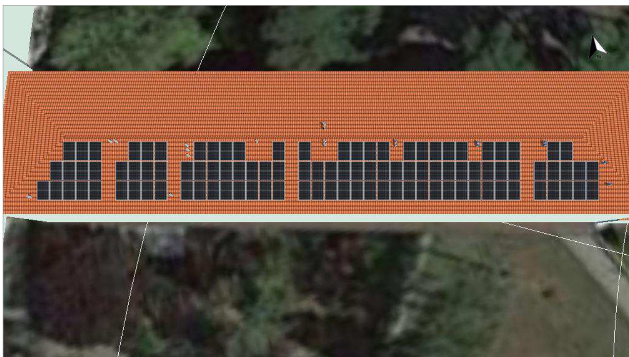
Obrázek: Umístění modulu - Budova E-1.5-Plocha střechy Jih
