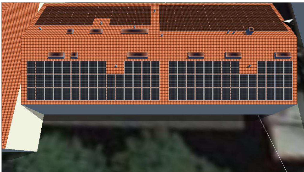
Obrázek: Umístění modulu - Budova D-1.1-Plocha střechy Západ
