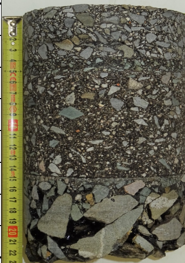
Vývrt JV 16 silnice II/379 Lipůvka - Blansko staničení km 3,240 L
