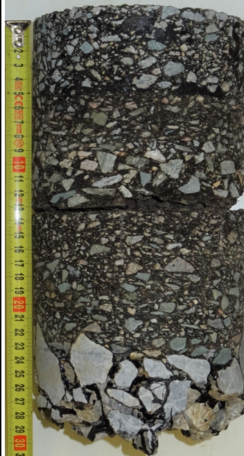
Vývrt JV 26 - S 12 silnice II/379 Lipůvka - Blansko staničení km 0,075 P
