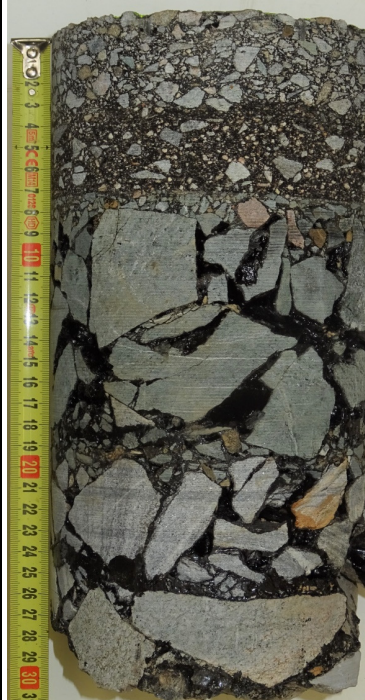
Vývrt JV 14 silnice II/379 Lipůvka - Blansko staničení km 2,780 L
