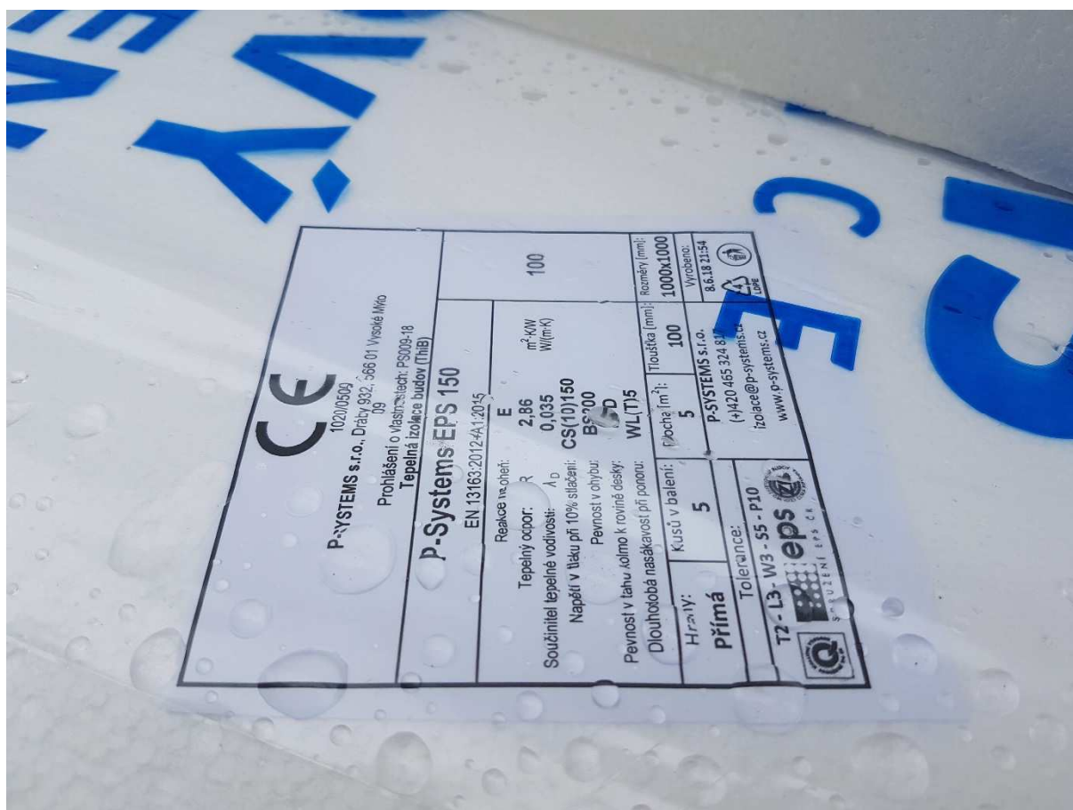
Fotografie 16 – Poskytnuto objednatelem zprávy – Pořízeno při dříve prováděné rekonstrukci. Štítek EPS.
