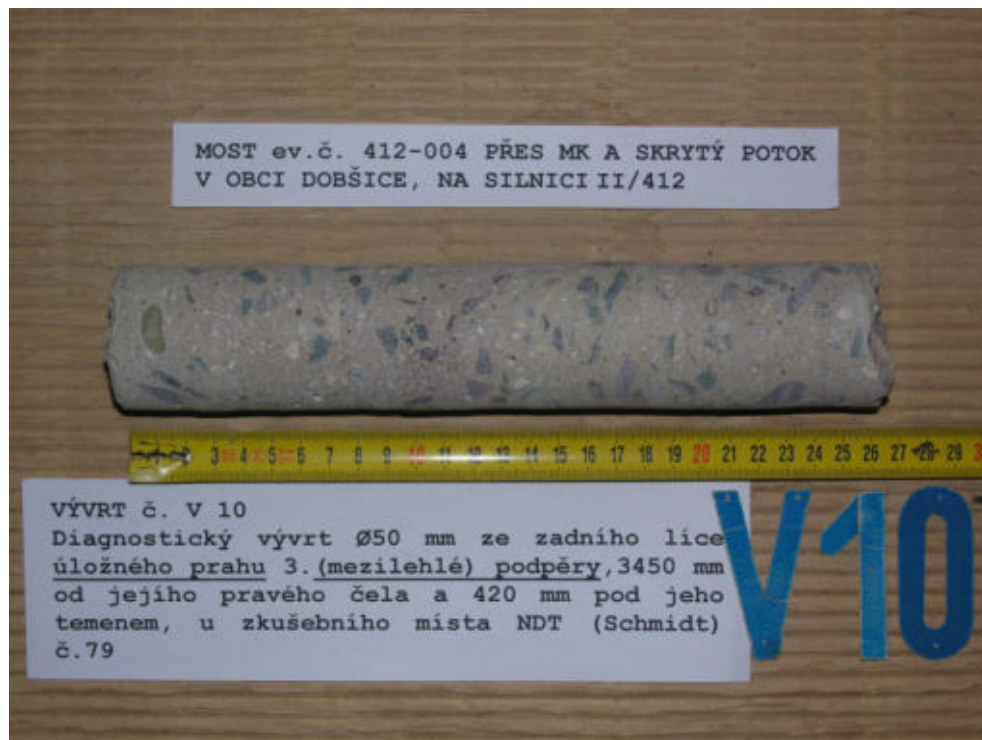
Obr. F78-310 VÝVRT č. V10. Diagnostický vývrt \varnothing 50 mm ze zadního líce úložného prahu 3. (mezilehlé) podpěry , 3450 mm od jejího pravého čela a 420 mm pod jeho temenem, u zkušebního místa NDT (Schmidt) č.79.
