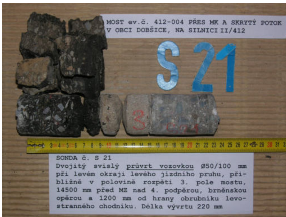
Obr.F78-101 SONDA č. S21. Dvojitý svislý průvrt vozovkou a spádovou vrstvou Ø50/100 mm při levém okraji levého jízdního pruhu, přibližně v polovině rozpětí 3. pole mostu, 14500 m před MZ nad 4. podpěrrou a 1200 mm od hrany obrubníku levostranného chodníku. Délka vývrtu 225 mm (na obr. chybně uvedeno 220 mm).
