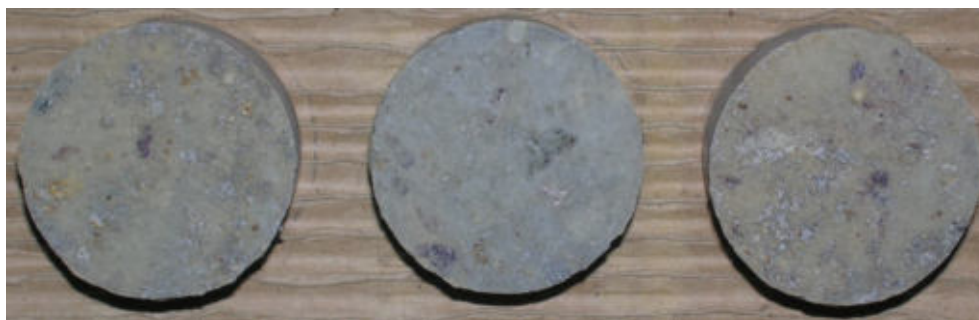
Obr.F78-204 Zkušební terče číslo 76, 101, 144 (zkušební místo 5) po provedení odtrhu.
