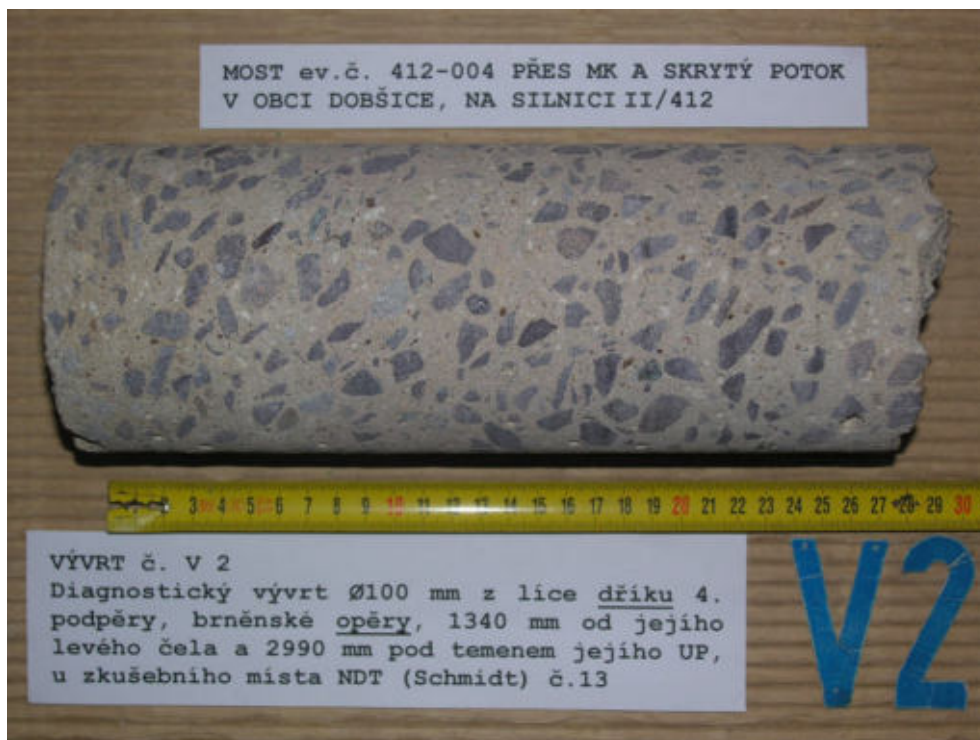
Obr. F78-301 VÝVRT č. V2. Diagnostický vývrt \varnothing 100 mm z líce dříku 4. podpěry, brněnské opěry , 1340 mm od jejího levého čela a 2990 mm pod temenem jejího UP, u zkušebního místa NDT (Schmidt) č.13.
