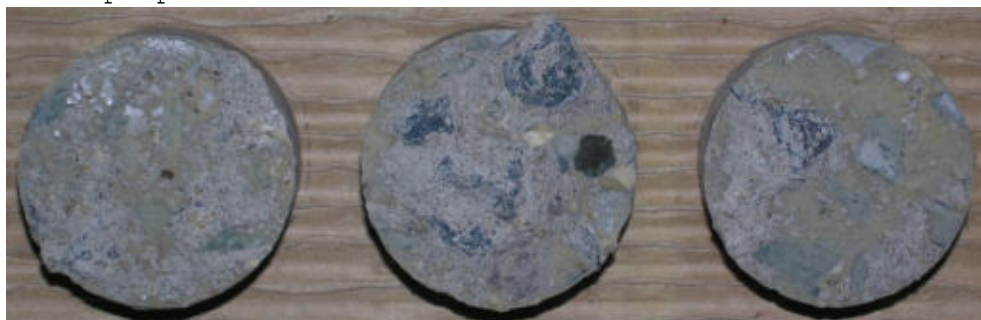
Obr.F78-201 Zkušební terče číslo 12, 13, 123 (zkušební místo 2) po provedení odtrhu.
