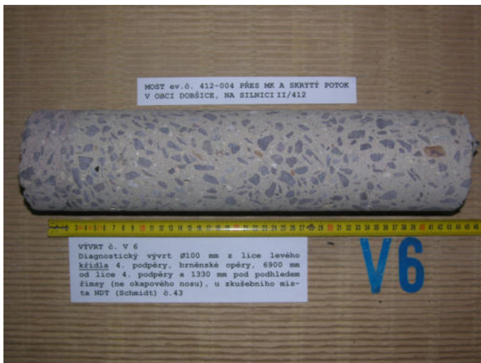
Obr. F78-306 VÝVRT č. V6. Diagnostický vývrt Ø100 mm z líce levého křídla 4. podpěry, brněnské opěry, 6900 mm od líce 4. podpěry a 1330 mm pod pohledem římsy (ne okapového nosu), u zkušebního místa NDT (Schmidt) č.43.
