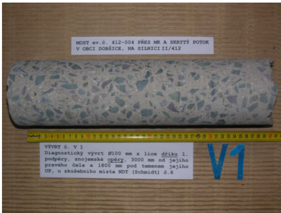
Obr. F78-300 VÝVRT č. V1. Diagnostický vývrt \varnothing 100 mm z líce dříku 1. podpěry, znojenské opěry , 3000 mm od jejího pravého čela a 1800 mm pod temenem jejího UP, u zkušebního místa NDT (Schmidt) č.6.
