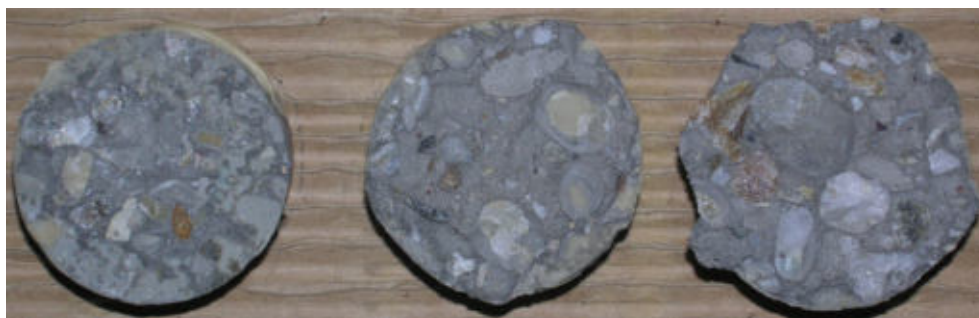
Obr.F78-206 Zkušební terče číslo 97, 107, 141 (zkušební místo 7) po provedení odtrhu.
