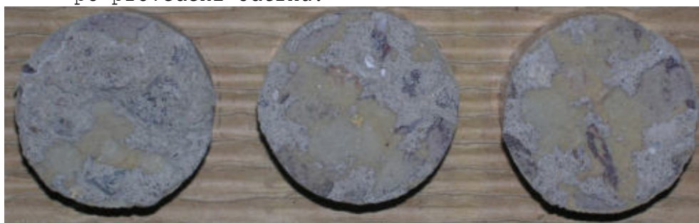
Obr.F78-203 Zkušební terče číslo 109, 153, 193 (zkušební místo 4) po provedení odtrhu.
