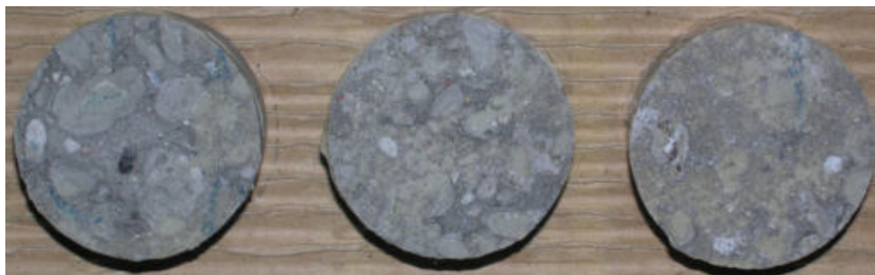
Obr.F78-205 Zkušební terče číslo 45, 77, 175 (zkušební místo 6) po provedení odtrhu.
