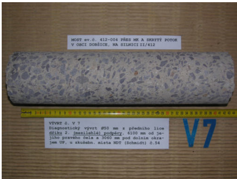
Obr. F78-307 VÝVRT č. V7. Diagnostický vývrt Ø100 mm z předního líce dříku 2. (mezilehlé) podpěry, 6100 mm od jejího pravého čela a 3060 mm pod dolním okrajem UP, u zkušebního místa NDT (Schmidt) č.54 (na foto chybně Ø50 mm).
