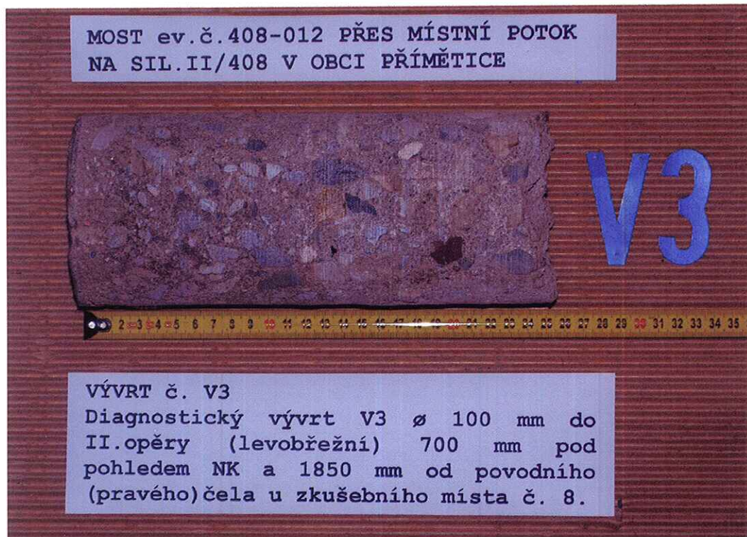
859-23 Diagnostický vývrt č.V3 \varnothing 100 mm z (levobřežní) II. opěry (leobřežní) 700 mm pod pohledem NK a 1850 mm od povodního (pravého) čela u zkušebního místa č. 8.
