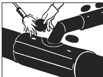
11. Navrtáme otvory pro pění a odvzdušnění
