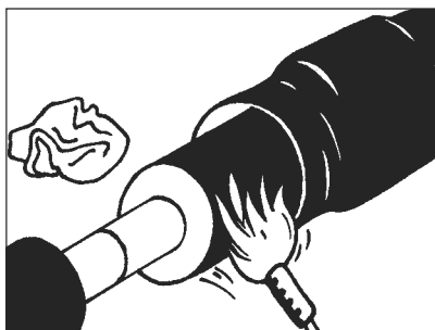
Obr. 6. Za použití měkkého plamene vysušte povrch plášťové trubky a pouzdra. Použijte čistý hadr k očištění povrchu na plášťové trubce a CSC pouzdra.
