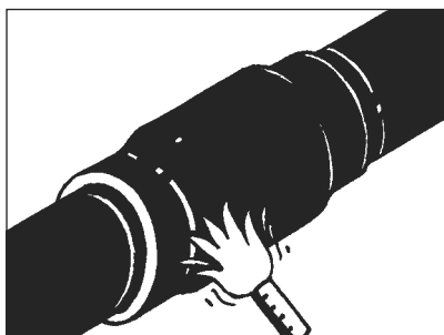
Obr. 22. Středním plamenem začneme smršťovat jeden konec CSC pouzdra rovnoměrně kolem dokola. Nahřívejte po celém obvodu stejně. Zkontrolujte správné nahřátí CSC pouzdra ve spodní části.
