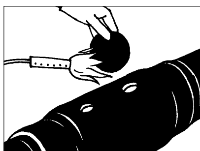
Obr. 39. Nahřejte lepicí stranu kruhové záslepky pomocí středně silného plamenu dokud lepidlo nedosáhne tavné teploty.
