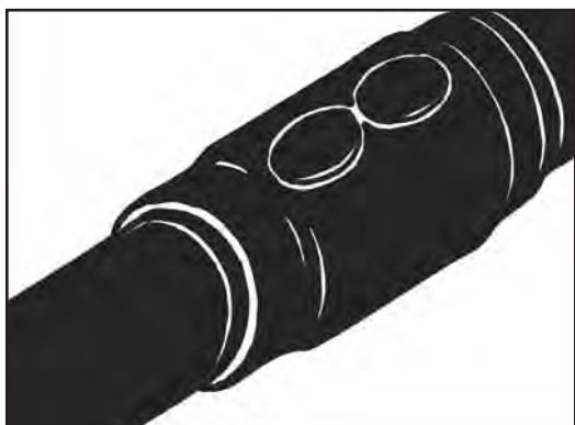
Obr. 43. Spoj je dokončen v případě, že všechny těsnící hrany jsou dokonale spojeny se spodním povrchem.
