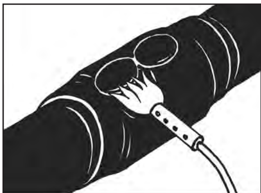
Obr. 41. Slabým plamenem nahřejte kruhové záslepky z vrchní strany dokud lepidlo nezačne vytékat zpod záslepky. Nepřehřejte povrch záslepek.
