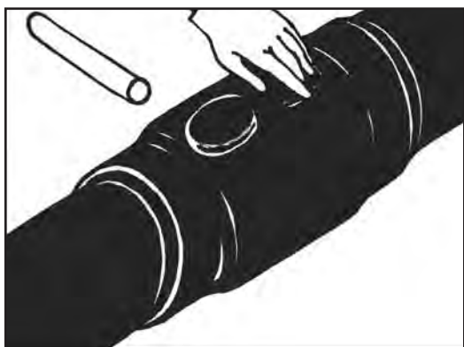
Obr. 42. Pro svařitelné zátky platí: Pomocí dlaně nebo válečkem vyhladte povrch záslepek. Ujistěte se, že lepidlo vyteklo zpod záslepek po celém jejich obvodu.
