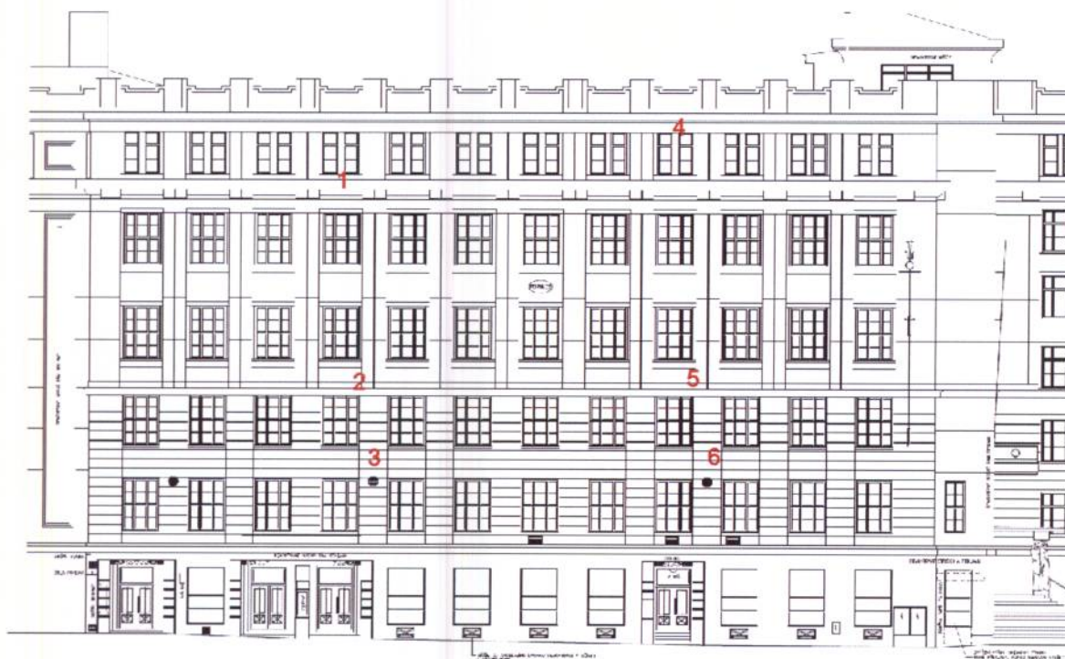
Obr. 1 Místa odběru vzorků omítky – jihovýchodní fasáda
