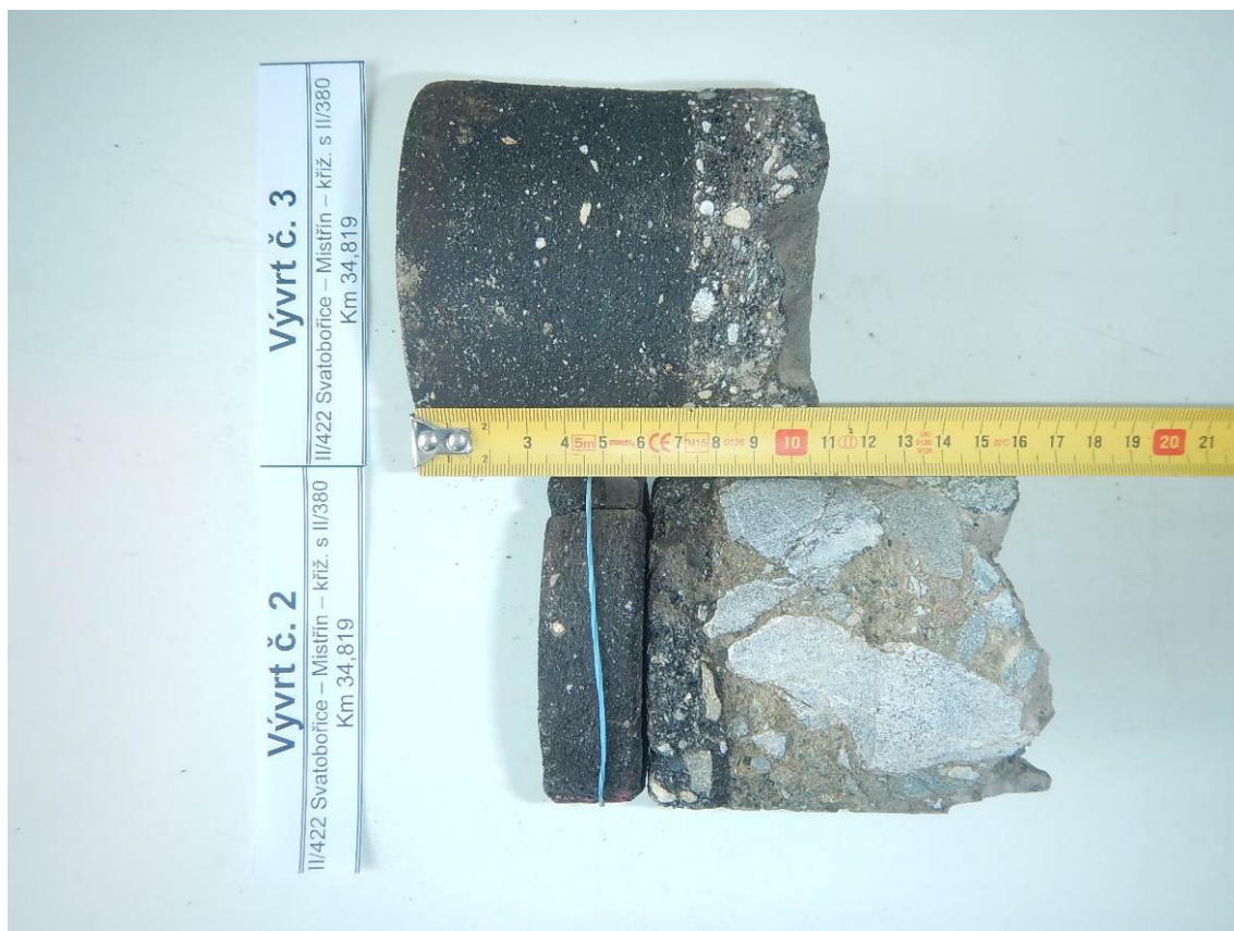
Foto č. 5 – Detail vývrtů č. 2 a 3 (znázornění trvalé deformace -kolej)
