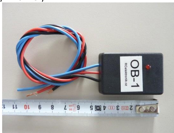
Obrázek 4: Multifunkční odpojovač spotřebičů – rozměr
