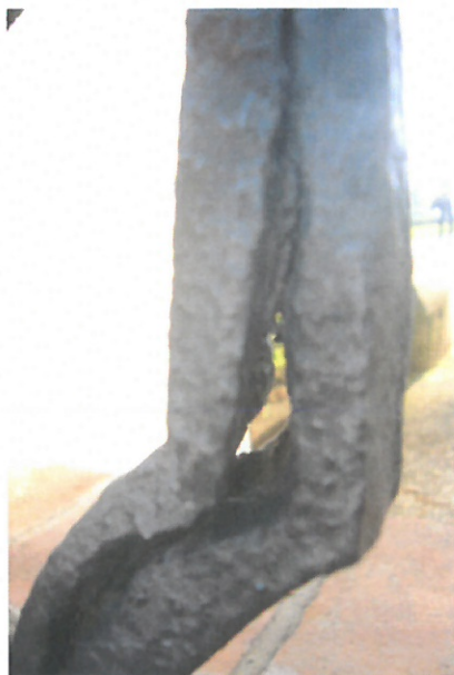
Narušený materiál silnou hloubkovou korozí
