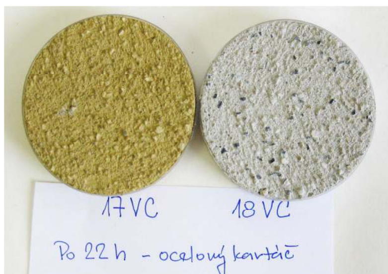
Obr. 17 Vzhled vzorků 17VC a 18VC – povrch ošetřený kartáčováním
