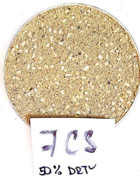
Obr. 12 Vzhled vzorku 7CS s polovičním množstvím bílé kamenné drti
