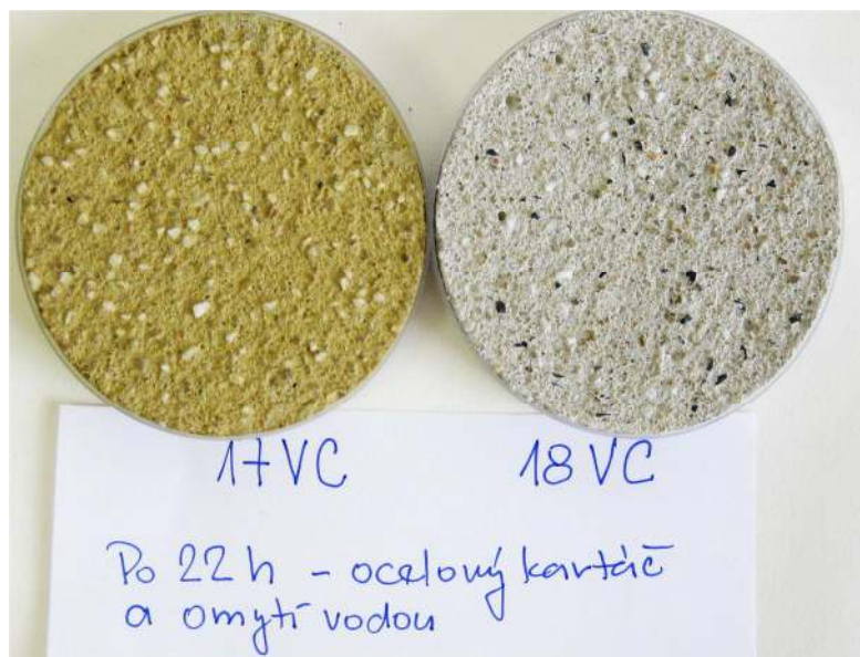
Obr. 18 Vzhled vzorků 17VC a 18VC – povrch po kartáčování a omytí vodou
