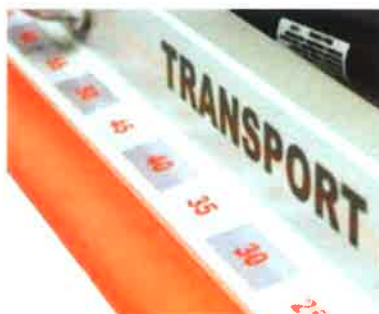
Řístenové měřičky na ramě ložka usnadňují přesné sestavení kazety.
