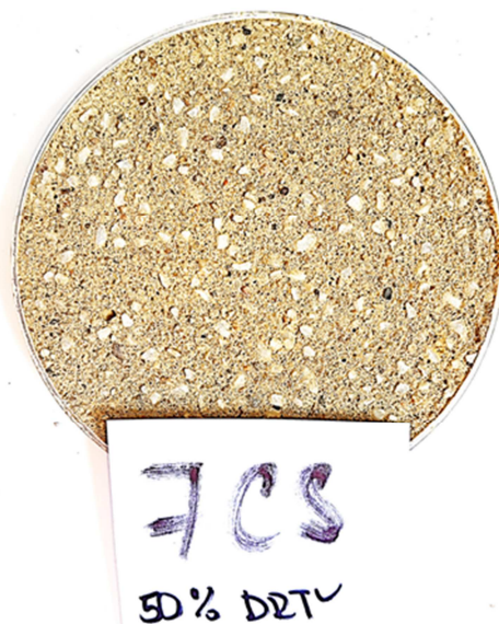
Obr. 12 Vzhled vzorku 7CS s polovičním množstvím bílé kamenné drti
