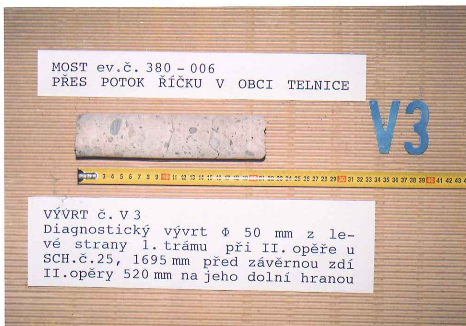
Obr.890-03 Diagnostický vývrt č. V3 \Phi 50 mm z levé strany 1. trámu při II. opěře u SCH. č. 25, 1695 mm před závěrnou zdí II. opěry a 520 mm nad jeho dolní hranou.
