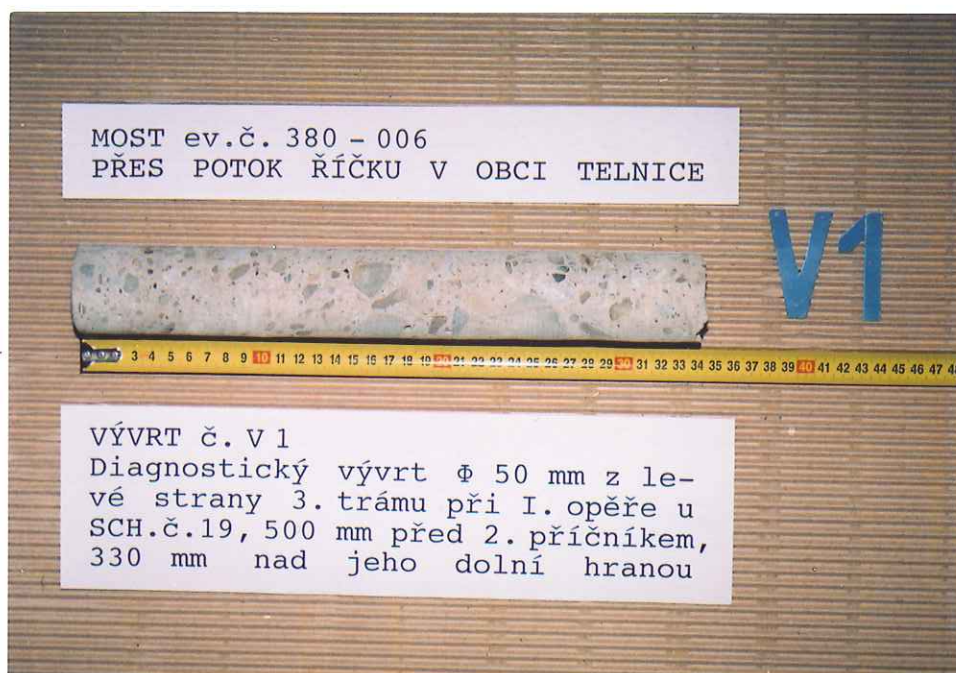
Obr.890-01 Diagnostický vývrt č. V1 \Phi 50 mm z levé strany 3. trámu při I. opěře u SCH. č. 19, 500 mm před 2. příčníkem a 330 mm nad jeho dolní hranou.
