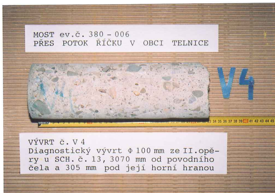
Obr.890-04 Diagnostický vývrt č. V4 \Phi 100 mm ze II. opěry u SCH. č. 13, 3070 mm od povodního čela a 305 mm pod její horní hranou.
