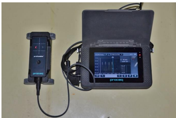
Obr. 1 Profometer PM-630 s dotykovým displejem a integrovanou sondou; svítící šipky pomáhají lokalizovat výztuž, na displeji lze ihned kontrolovat správnost měření pomocí křivek intenzity signálu.
