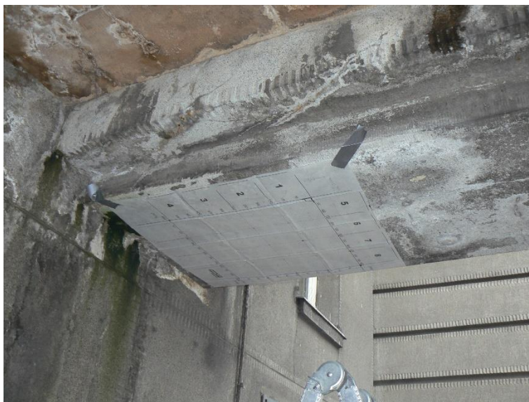
Obr. 6.11 Místo sondy KH3 ze spodního líce konzoly, na konstrukci je umístěn rastr pro provedení radarového skenu 600 x 600 mm.
