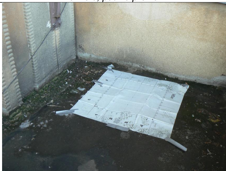
Obr. 6.12 Plošný radarový sken formátu 600 x 600 mm, pořízený ze spodního líce desky v místě sondy KH2. Na skenu není zobrazena žádná měkká výztuž, buď se nevyskytuje, nebo je zobrazení ovlivněno vrstvami konstrukce. V hloubce cca 200 mm pod povrchem je ale detekován objekt, který by mohl být tuhou výztuží v konzole, patrně profilem I.
