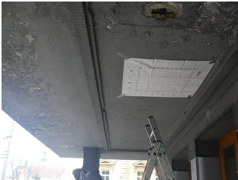
Obr. 5.1 Místo sondy KD1, na konstrukci je umístěn rastr pro provedení radarového skenu 600 x 600 mm.
