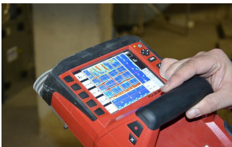
Obr. 4 Sonda přístroje Hilti PS1000, na displeji patrná poloha detekované výztuže v půdorysném schématu i řezech ve dvou, na sebe kolmých rovinách
