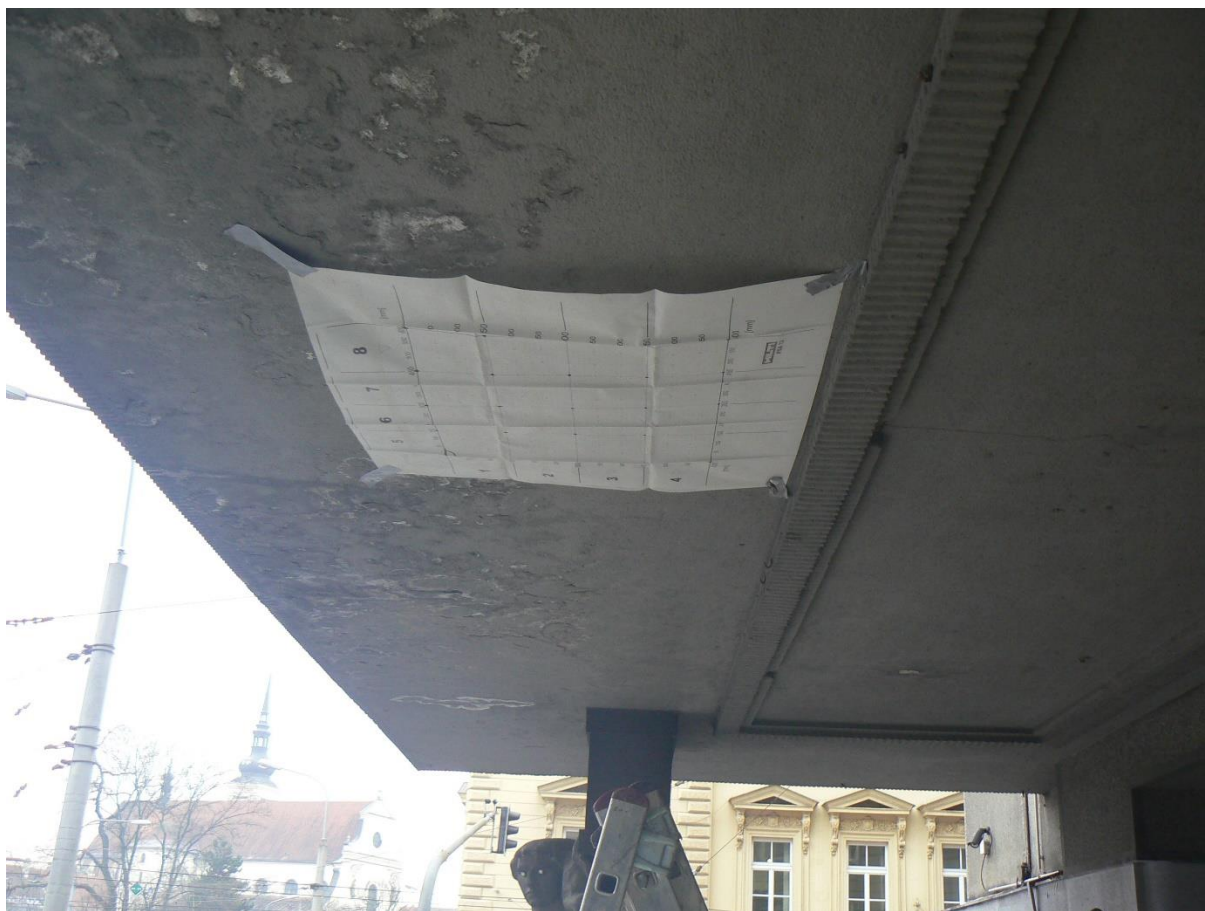
Obr. 5.11 Místo sondy KD3, na konstrukci je umístěn rastr pro provedení radarového skenu 600 x 600 mm.
