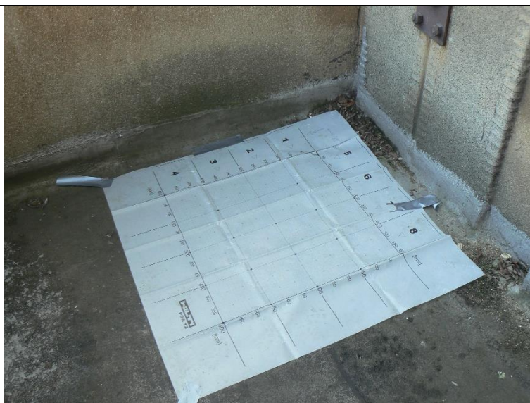
Obr. 6.5 Místo sondy KH1 z horního líce balkonu, na konstrukci je umístěn rastr pro provedení radarového skenu 600 x 600 mm.
