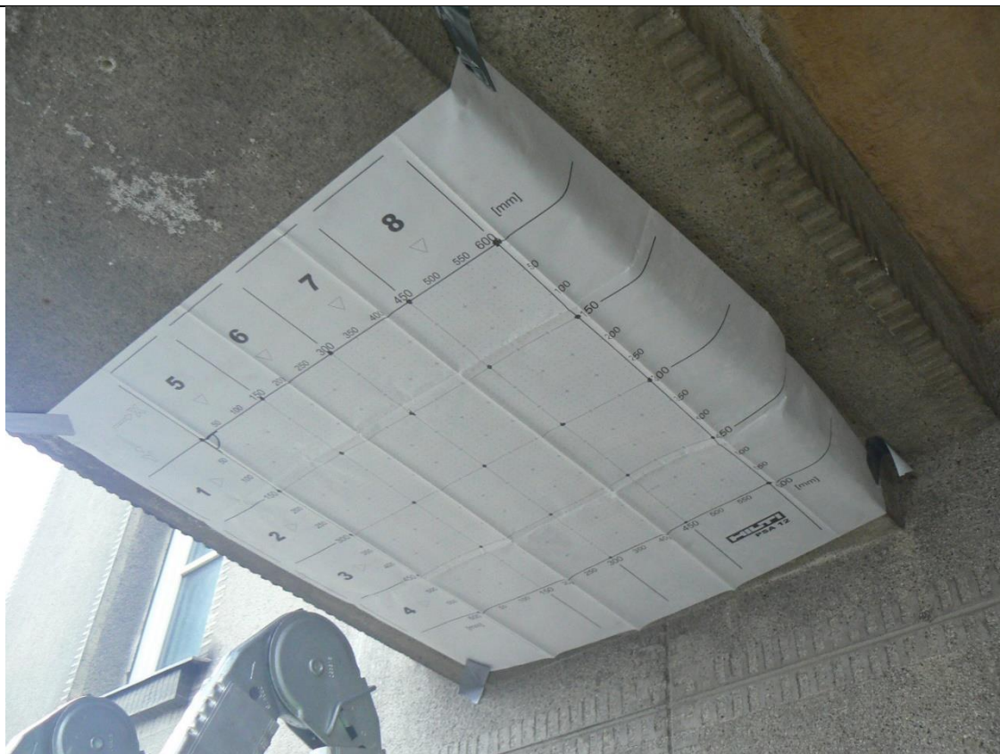
Obr. 6.1 Místo sondy KD3, na konstrukci je umístěn rastr pro provedení radarového skenu 600 x 600 mm.
