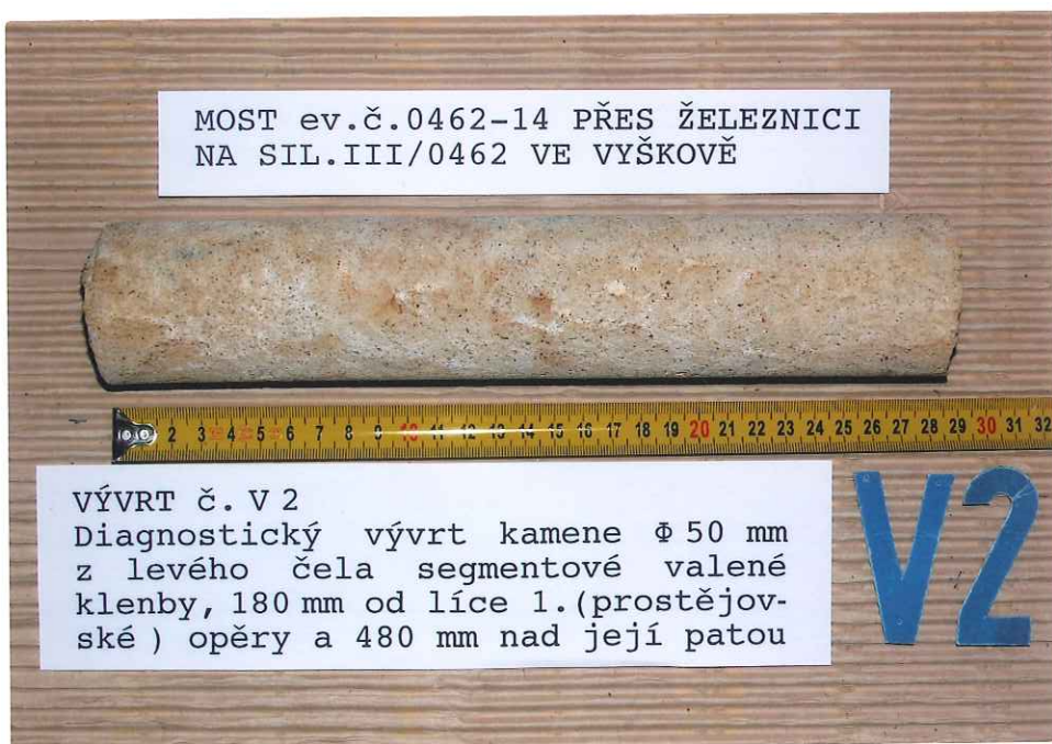
Obr.B57-262 Vývrt č. V2. Diagnostický vývrt kamene \Phi 50 mm z levého čela segmentové valené klenby, 180 mm od líce 1. prostějovské opěry a 480 mm nad její patou, - místo vývrtu je patrné na obr. B57-025 (horní otvor).
