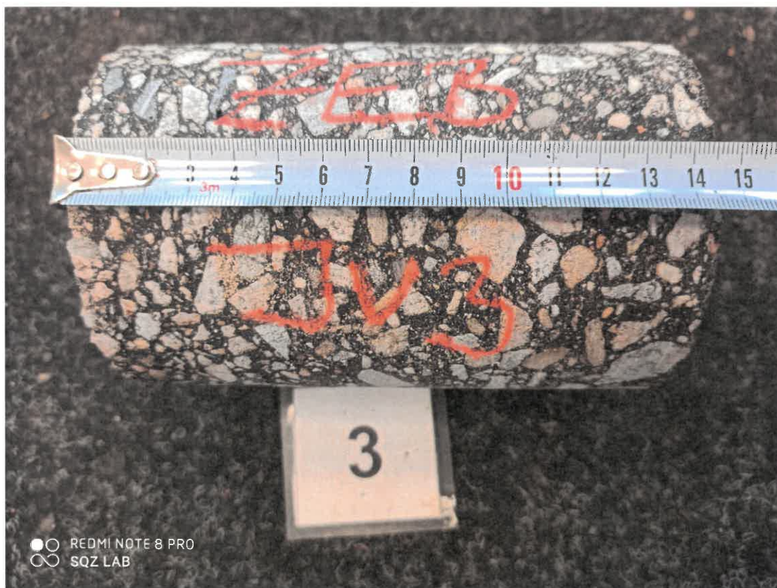
Obr.7 AC vývrt JV3
