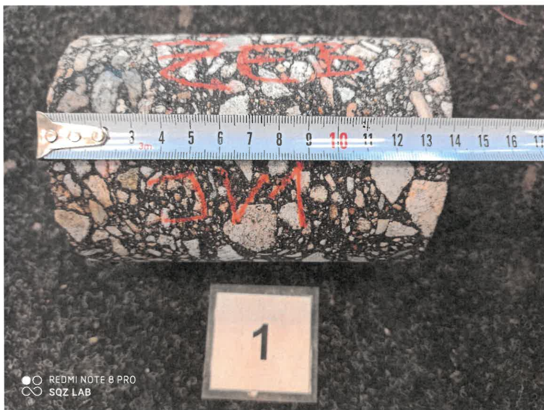
Obr. 5 AC vývrt JV1
