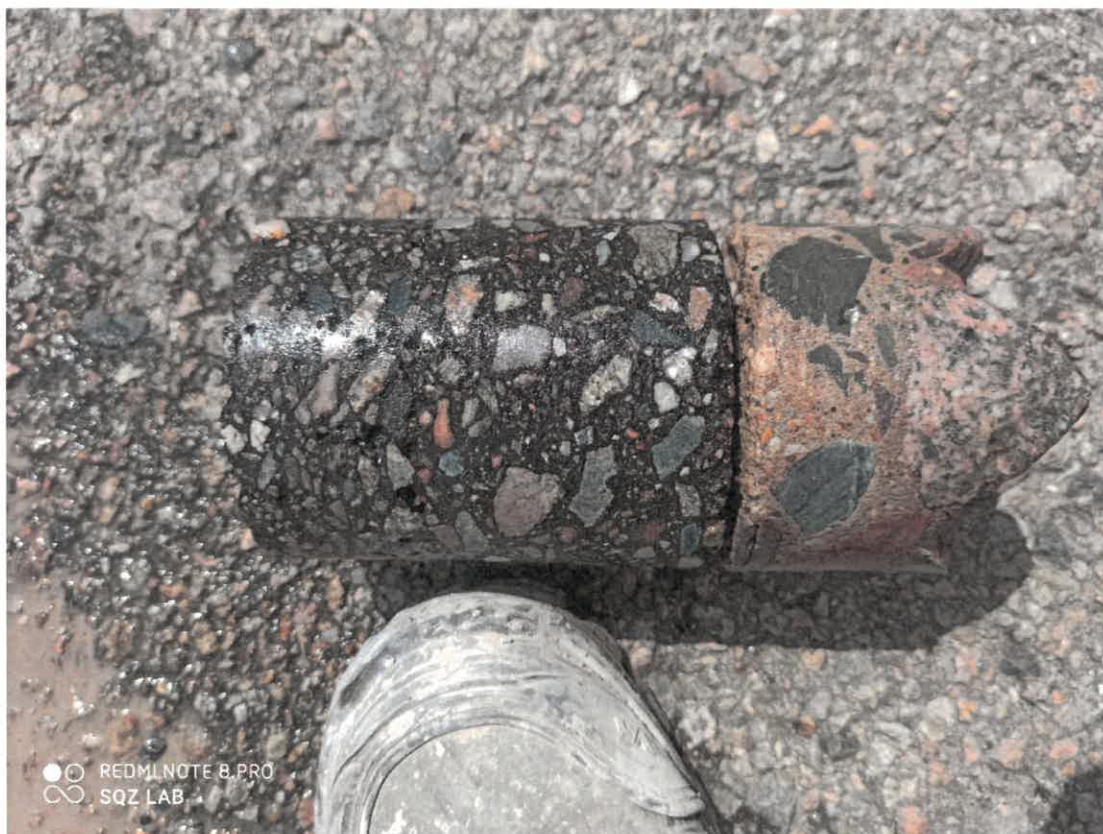
Obr. 9 AC vývrt JV2 se zbytky podkladní cementové stabilizace
