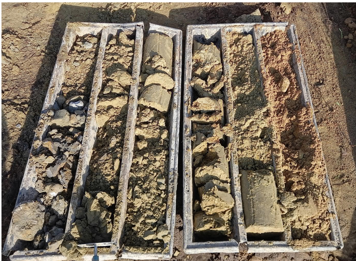
Foto 6 Profil vsakovací sondy VS-3
