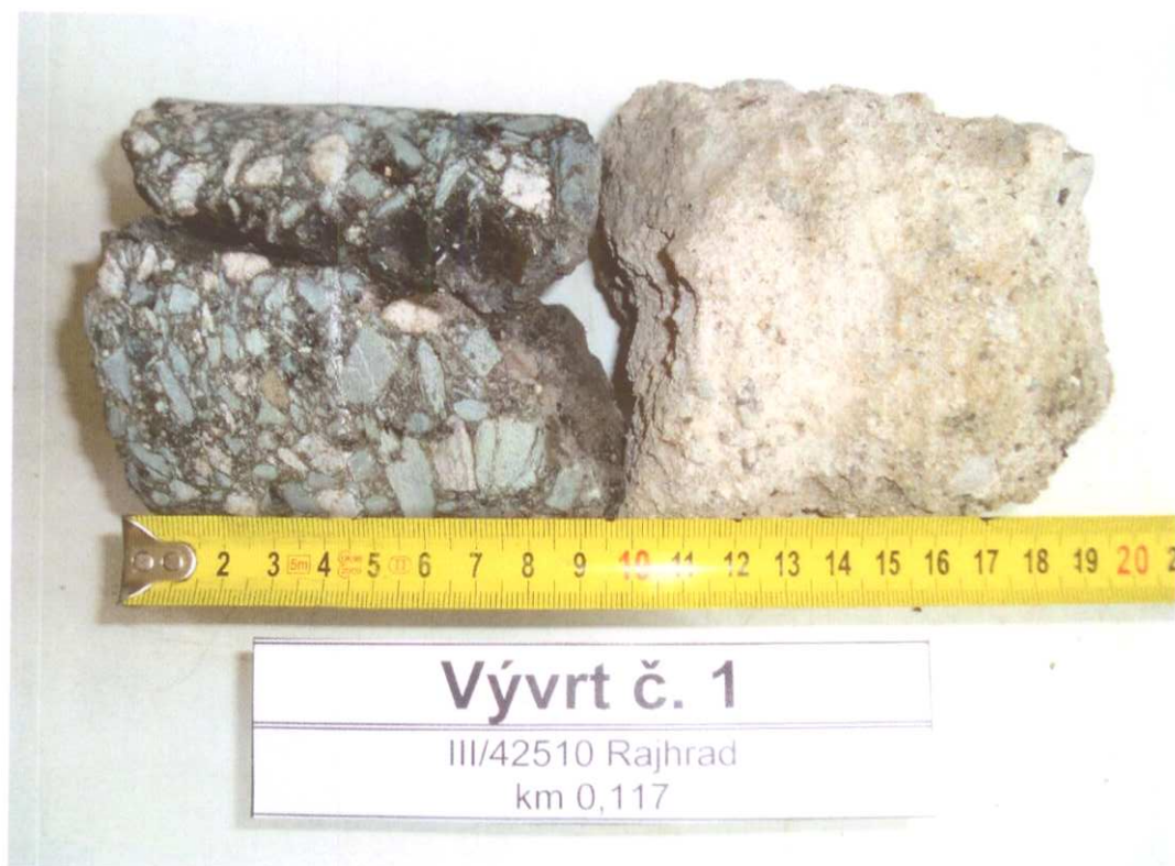
Foto č. 1 – Detail vývrtu č. 1
