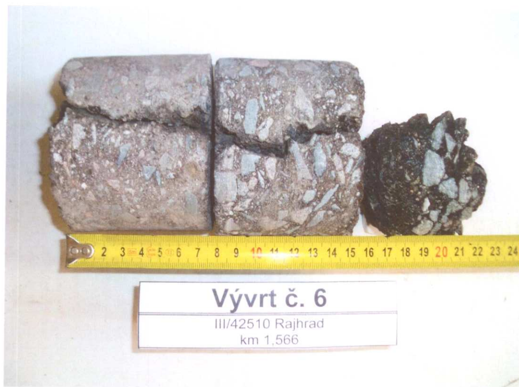
Foto č. 7 – Detail vývrtu č. 6
