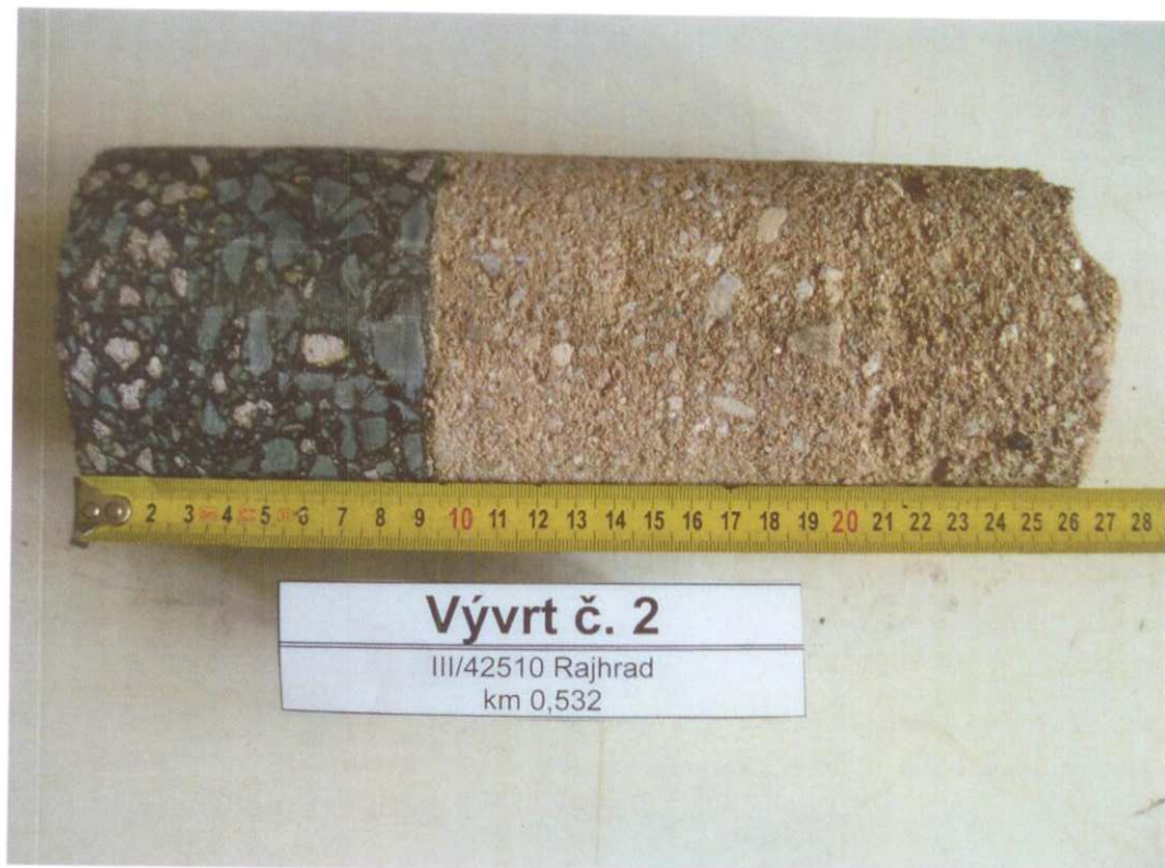
Foto č. 2 – Detail vývrtu č. 2
