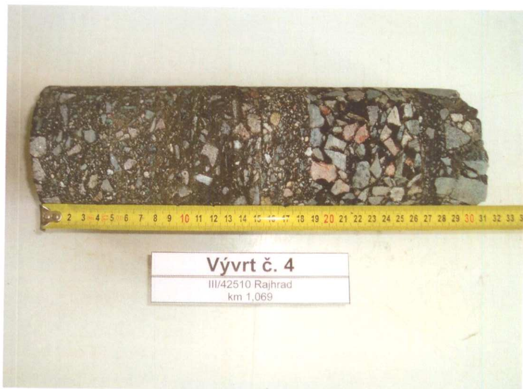
Foto č. 4 – Detail vývrtu č. 4
