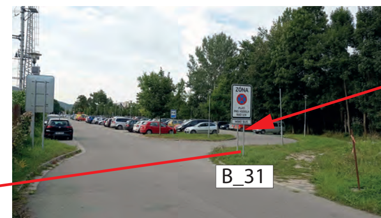
NA SLOUPEK POD DZ IZ 8a INSTALOVAT IS21a
