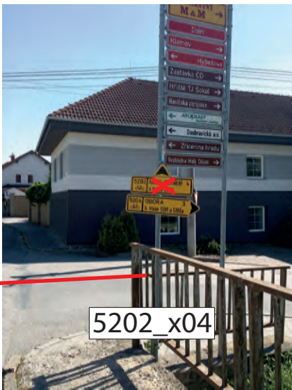
DEMONTOVAT STÁVAJÍCÍ IS 19a RUŠENÉ TRASY (5202) ZE SLOUPKU DZ IOS
