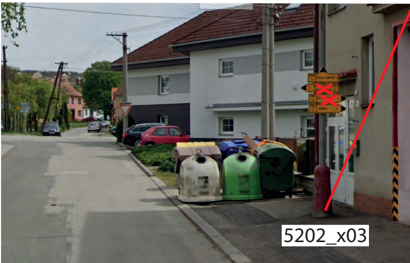
DEMONTOVAT STÁVAJÍCÍ IS 19b a IS 19c RUŠENÉ TRASY (5202) ZE SLOUPU OSVĚTLENÍ PŘEVĚSIT IS19c (5204) POD IS 19a (5204A)
