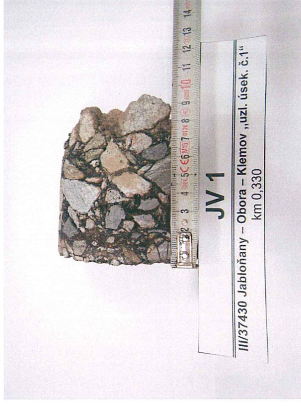
Foto č. 2 – Detail vývrtnu JV 1 (úsek č.1)
