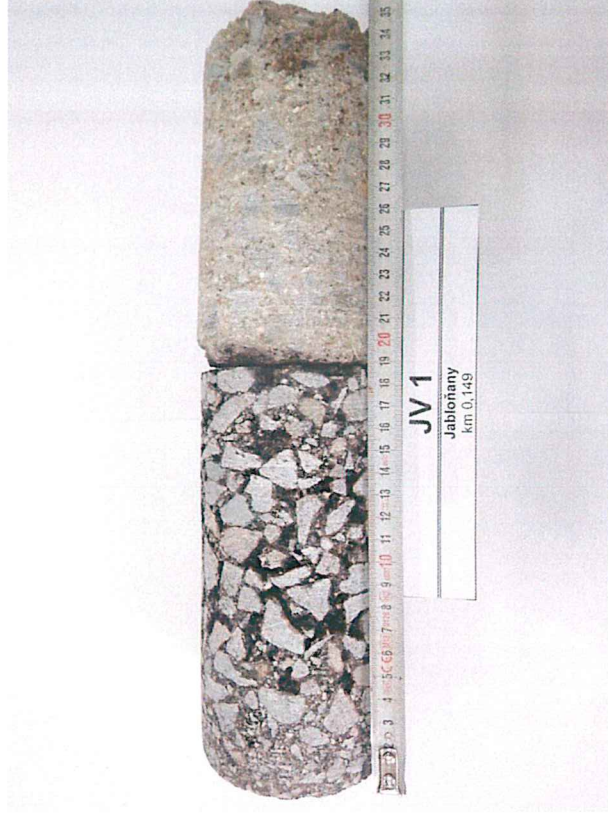
Foto č. 12 – Detail vývrtnu JV 1 (úsek č.1)
