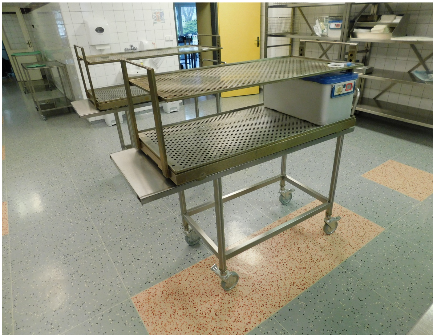
Rozměr roštu na obrázku – 60 x 120 cm, na roštu zobrazen největší používaný kontejner rozměru 27 x 27 x 54 cm
