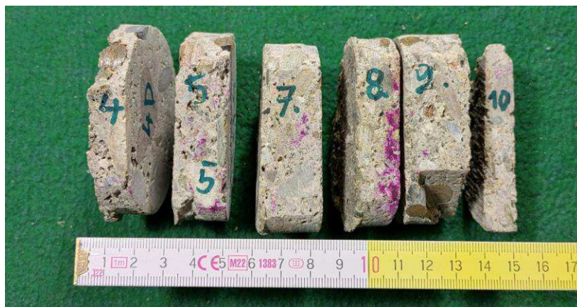
Obr. 9: Fenolftaleinový test na čerstvých řezech krajních částí betonových vzorků N 4, N 5, N 7, N 8, N 9 a N 10 (další vzorky neobsahovaly spodní stranu desky nebo byl odřezek velmi krátký a při řezání se rozpadl). Karbonatace u zkoušených vzorků postoupila do hloubky větší než tloušťka odřezku, s výjimkou N 8. Proto byla doměřena po rozdrcení těles v lisu.
