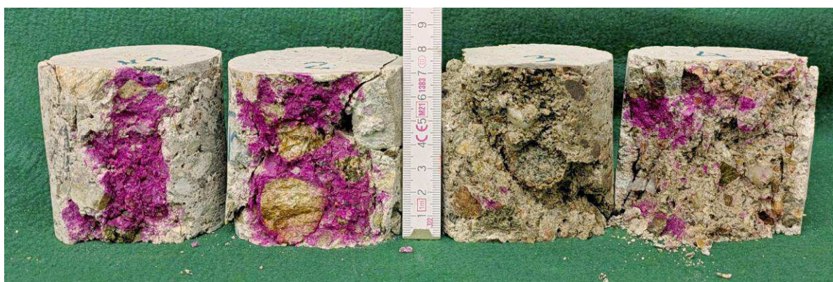
Obr. 10: Fenolftaleinový test provedený po rozdrcení zkušebních těles N 1 až N 4. Zatímco u vzorků N 1 a N 2 je po celé výšce průřezu \text{pH} \geq 9,5 , u vzorku N 3 je zkarbonatován celý průřez desky, u vzorku N 4 téměř celý průřez.
