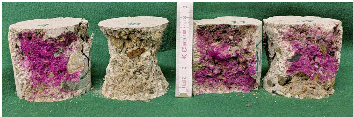
Obr. 12: Fenolftaleinový test provedený po rozdrčení zkušebních těles N 9 až N 12. Beton vzorku N 10 je zkarbonatován v celém průřezu.
