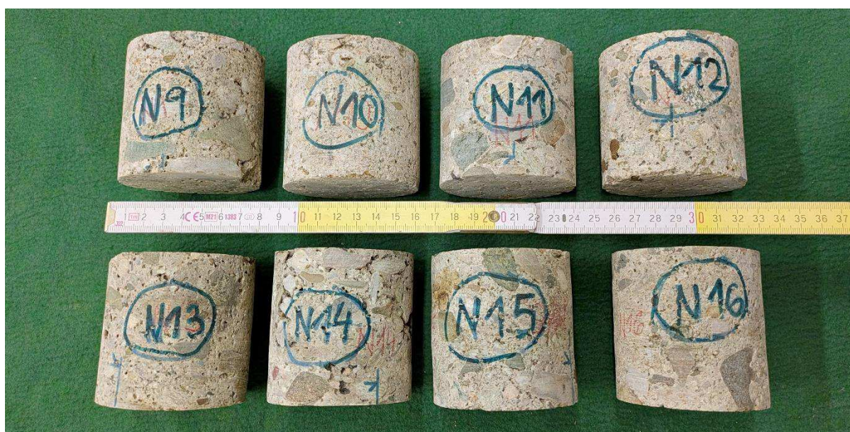
Obr. 7: Zkušební tělesa ve tvaru válce 1:1 vyrobená ze vzorků N 9 až N 16.
