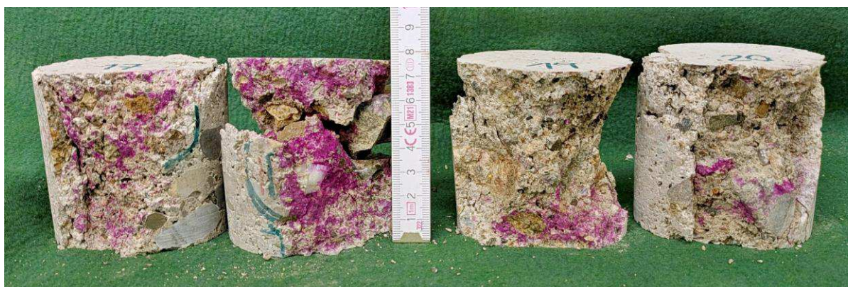
Obr. 14: Fenolftaleinový test provedený po rozdrčení zkušebních těles N 17 až N 20. U vzorků N 19 a N 20 karbonatace postupovala shora a zasáhla prakticky celý průřez.
