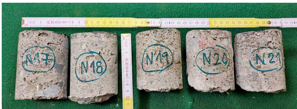
Obr. 5: Zkušební vzorky N 17 až N 21 v délkách 100, 105, 90, 90 a 90 mm odebrané z desek. Vzorek N 21 byl šikmo odlomen a nemohlo z něj být vyrobeno těleso se štíhlostí 1:1.
