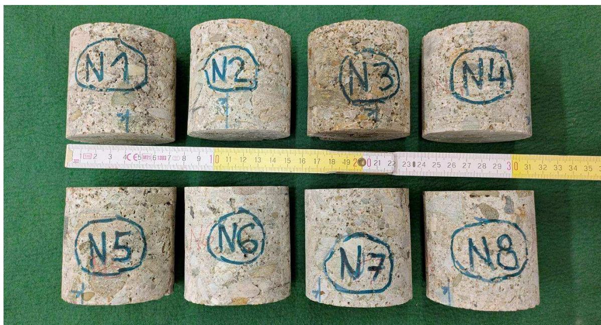
Obr. 6: Zkušební tělesa ve tvaru válce 1:1 vyrobená ze vzorků N 1 až N 8.
