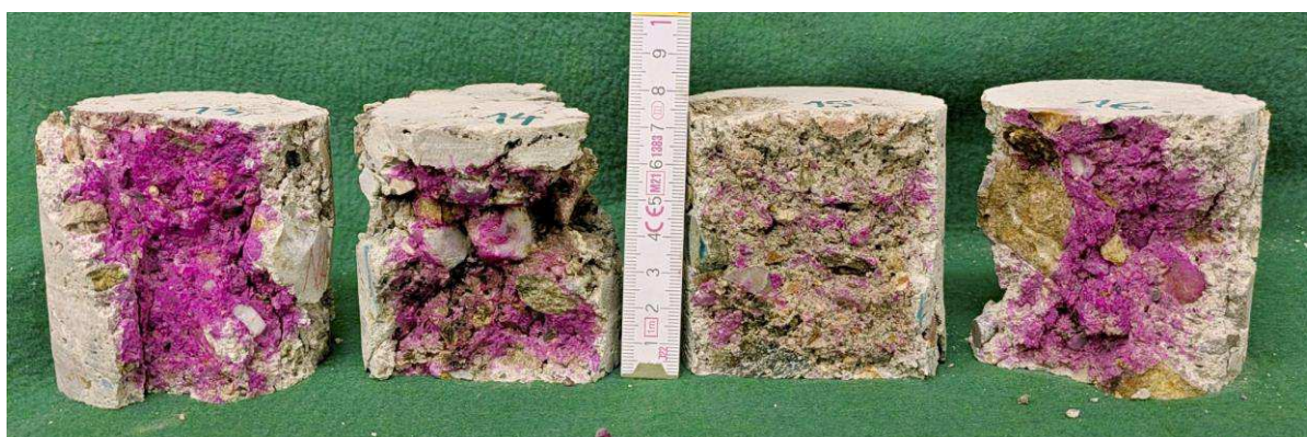
Obr. 13: Fenolftaleinový test provedený po rozdrčení zkušebních těles N 13 až N 16. Beton vzorku N 15 je zkarbonatován prakticky v celém průřezu.
