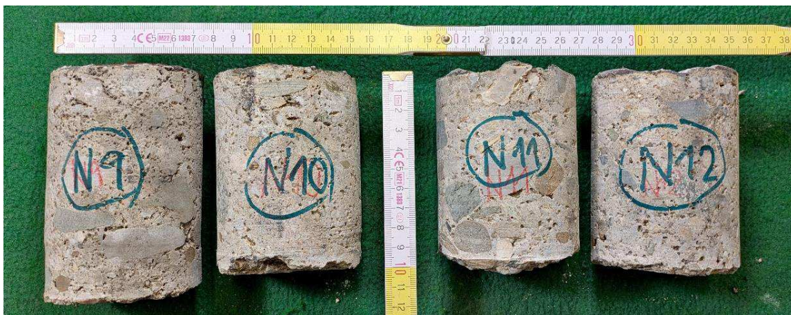
Obr. 3: Zkušební vzorky N 9 až N 12 v délkách 110, 95, 95 a 100 mm odebrané z desek.
