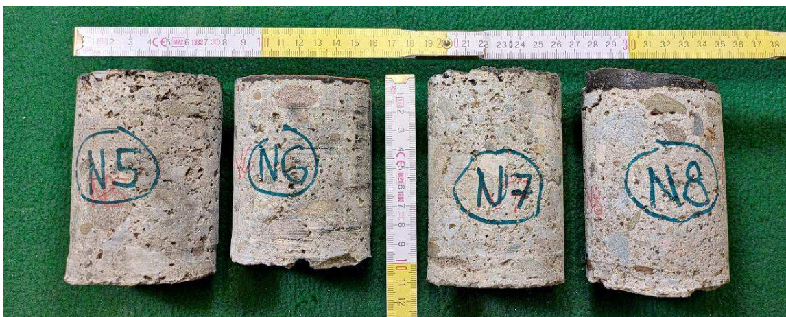
Obr. 2: Zkušební vzorky N 5 až N 8 v délkách 105, 95, 110 a 100 mm odebrané z desek.
