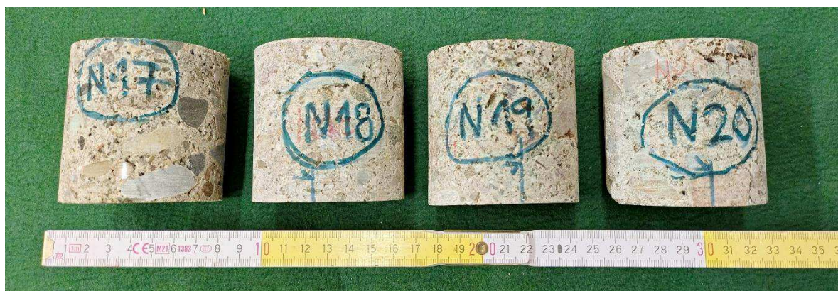
Obr. 8: Zkušební tělesa ve tvaru válce 1:1 vyrobená ze vzorků N 17 až N 20.
