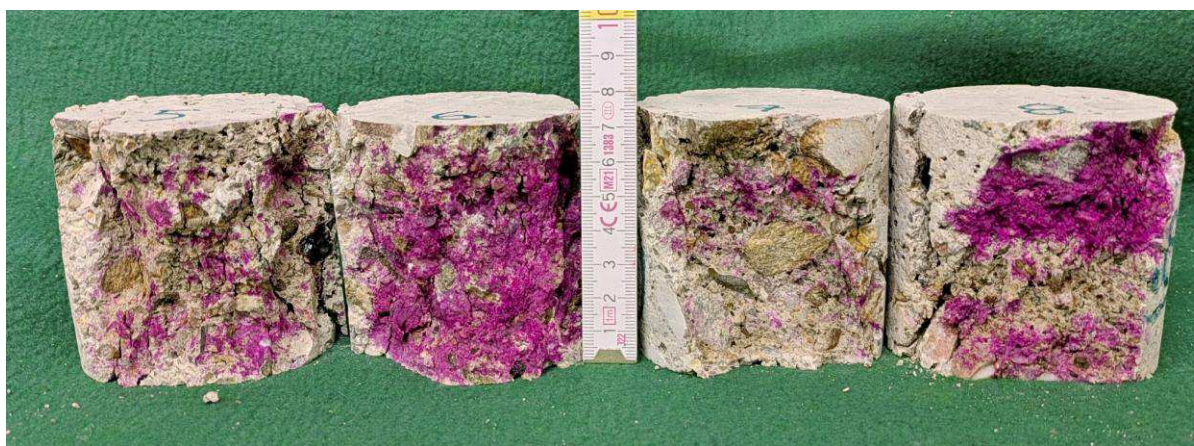
Obr. 11: Fenolftaleinový test provedený po rozdrcení zkušebních těles N 5 až N 8. U vzorků N 5 a N 7 je zkarbonatován téměř celý průřez, u vzorků N 6 a N 8 jen část průřezu.
