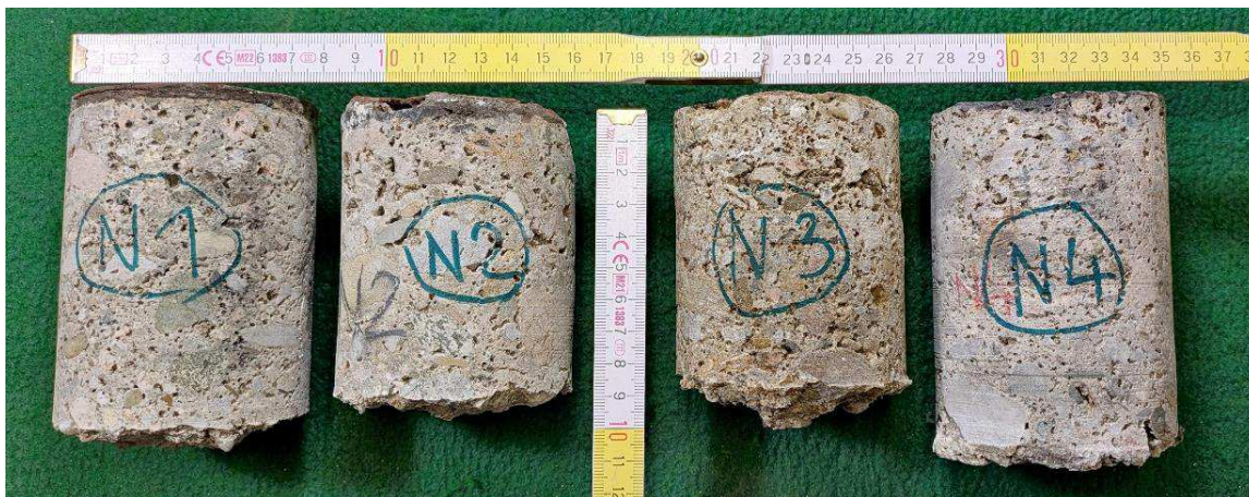
Obr. 1: Zkušební vzorky N 1 až N 4 v délkách 100, 85, 85 a 110 mm odebrané z desek. Vzorek N 3 je vizuálně horší kvality (vysoká pórovitost).
