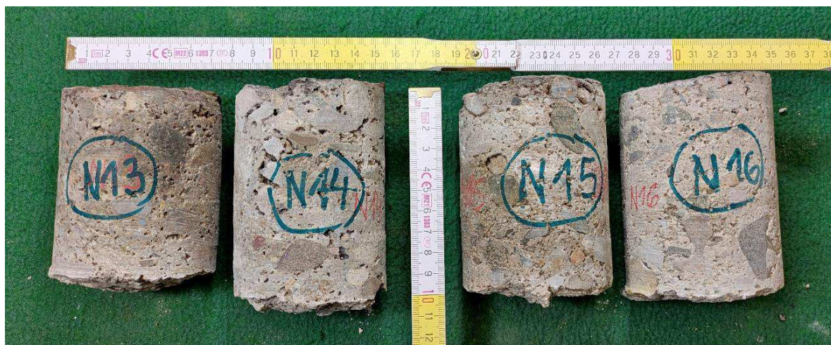
Obr. 4: Zkušební vzorky N 13 až N 16 v délkách 105, 100, 90 a 105 mm odebrané z desek. Vzorek N 14 je vizuálně horší kvality (dutinky na styku větších zrn kameniva).
