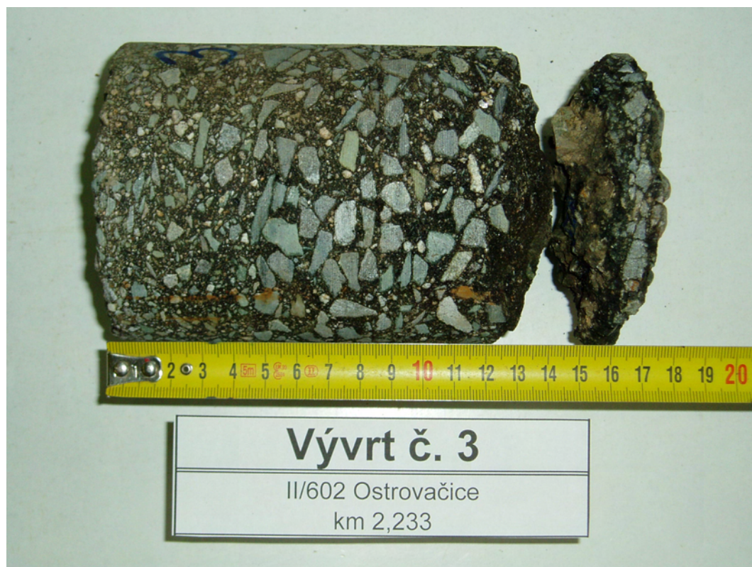
Foto č. 3 – Detail vývrtu č. 3
