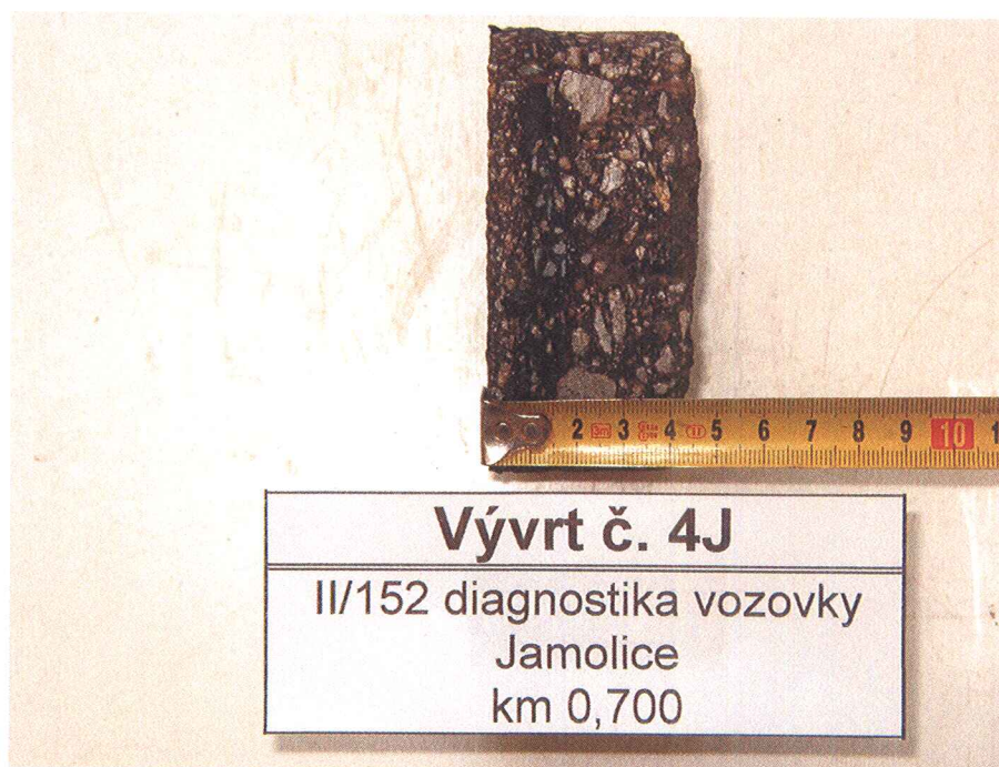
Foto č. 5 – Detail jádrového vývrtu č. 4J
