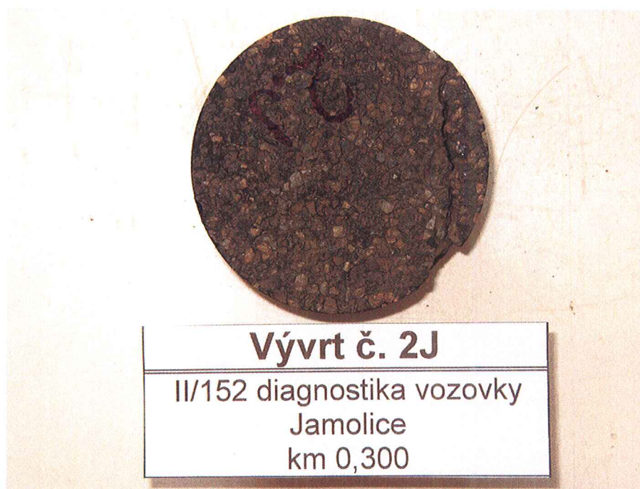
Foto č. 3 – Detail jádrového vývrtu č. 2J
