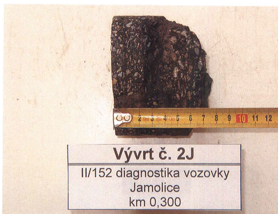
Foto č. 2 – Detail jádrového vývrtu č. 2J
