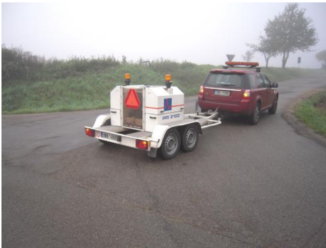
F01 – Silnice III/37413, začátek úseku - křižovatka s II/374; deflektometr FWD
